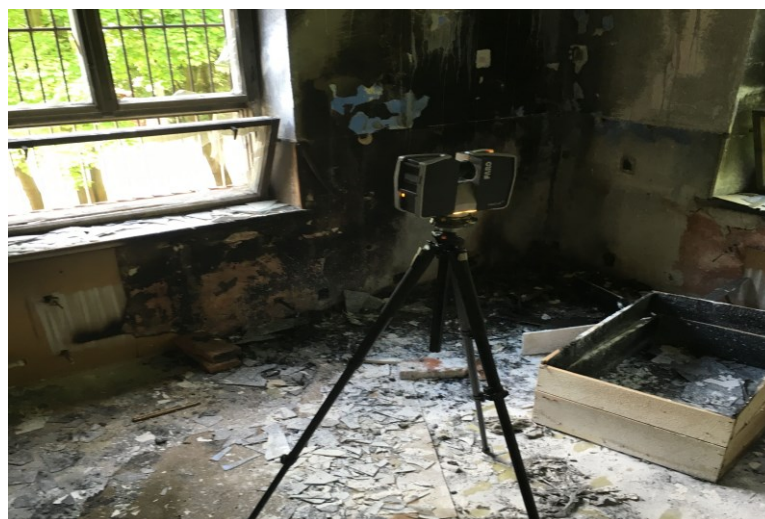
Obrázek 31. Postup při pořizování 3D skenu na místě činu [25]
