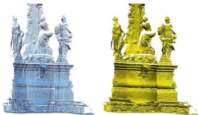
Obrázek 24. Ukázka dat mračna bodů (vlevo) a polygonová síť (vpravo)[22]
