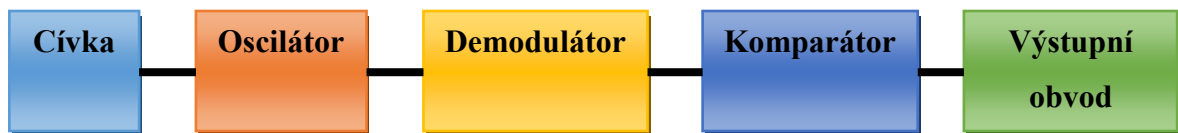
Obrázek 9. Blokové schéma indukčního snímače, [11] upravil Kučík 2016
