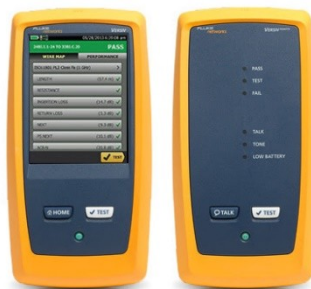
Obrázek 32: Certifikační měřicí přístroj FLUKE NETWORKS DSX 5000 [9]
