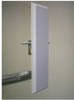
Obrázek 20: Sektorová anténa pro 5 GHz vyzařovací úhel 90^{\circ}\text{H} / 11^{\circ}\text{V} , zisk 15 dBi, PSV < 1.8
