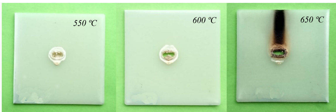
Obr. 26. Zkouška hořlavosti polypropylenu od 550 °C po 650 °C.
