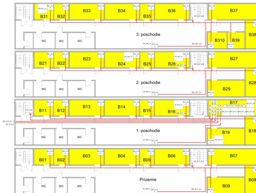
Obr. 48. B pavilón - pridané nové zariadenia a vedenia sieťovej kabeláže
