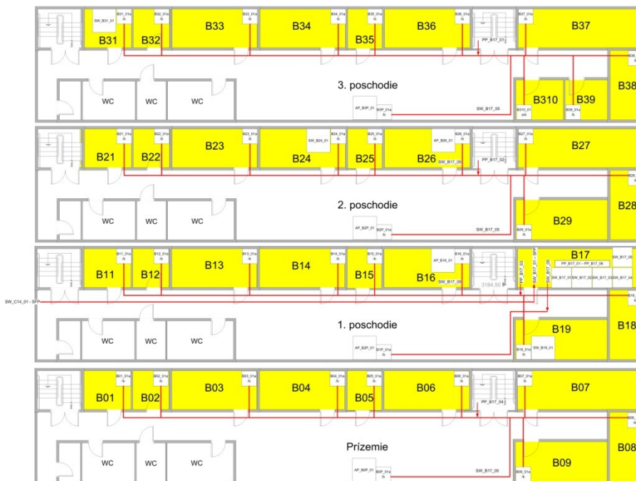
Obr. 61. B pavilón - pridané nové zariadenia a káble
