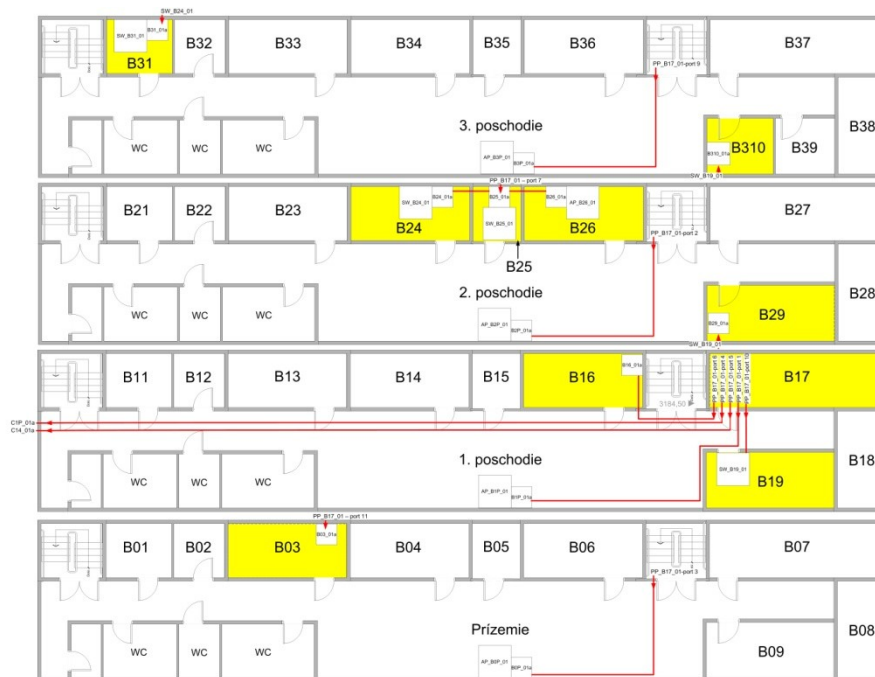
Obr. 41. B pavilón - pridané nové káble a zariadenia s popisom
