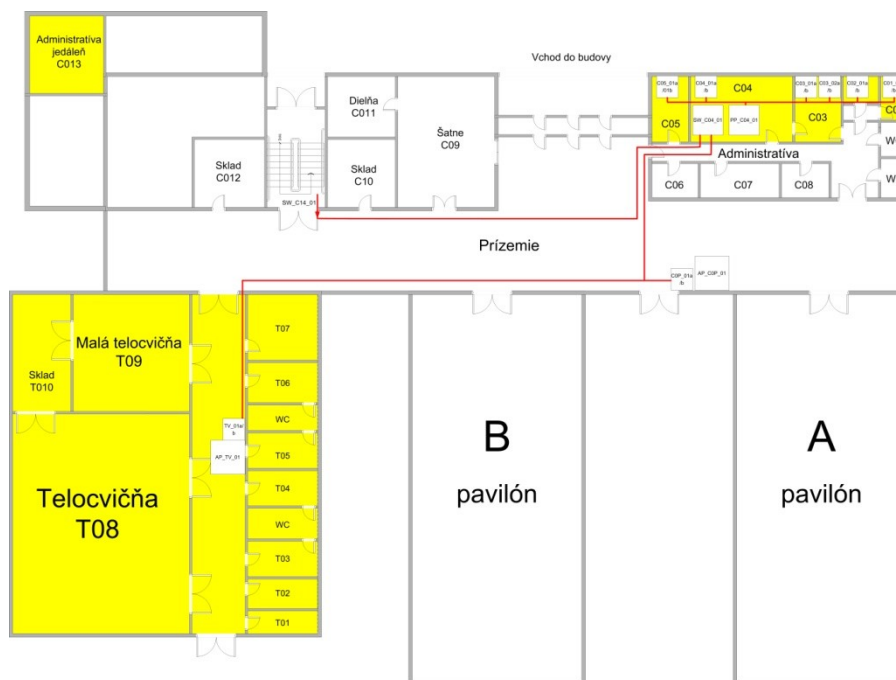
Obr. 63. Prízemie - pridané nové zariadenia a káble
