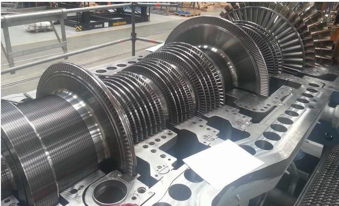
Obrázek 4 Rotor parní turbíny [26]
