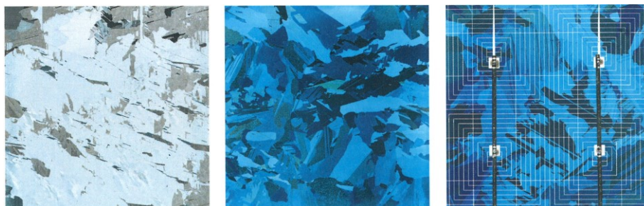
Obrázek 9 - Polykrystalický plátek s/bez antireflexní vrstvy [7]
