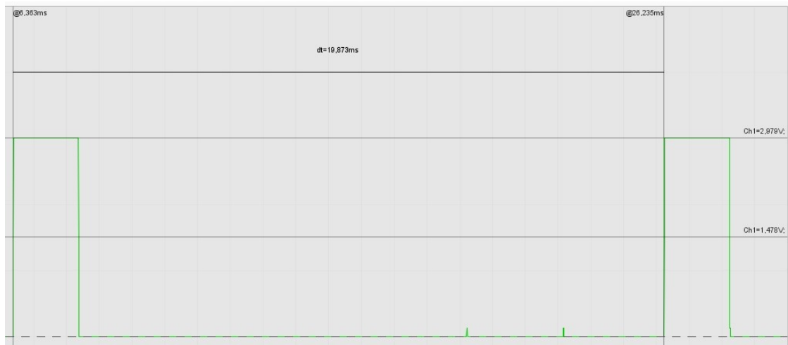
Obr. 22. Impulsní signál 50 Hz, kanál 1, střída 10%
