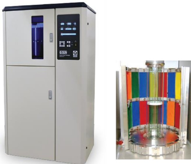
Obr. 2. Rotační Q-SUN Xe-2, detail uložení vzorků kolem lampy obklopené filtračním systémem
