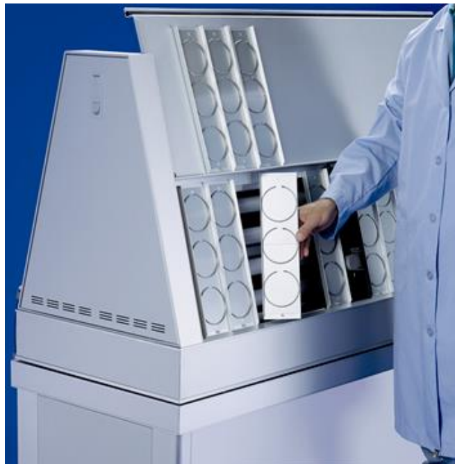
Obr. 7. Vkládání vzorků na držácích do stroje QUV
