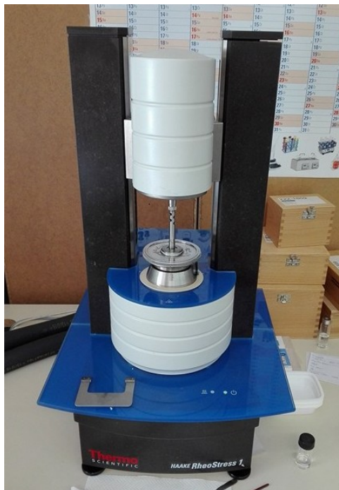
Obr. 4: Provádění dynamické oscilační reometrie na přístroji Thermo Scientific TM (RheoStress1, HAAKE) pro zjištění viskoelastických vlastností jednotlivých modelových vzorků tavených sýrů [foto autor práce].
