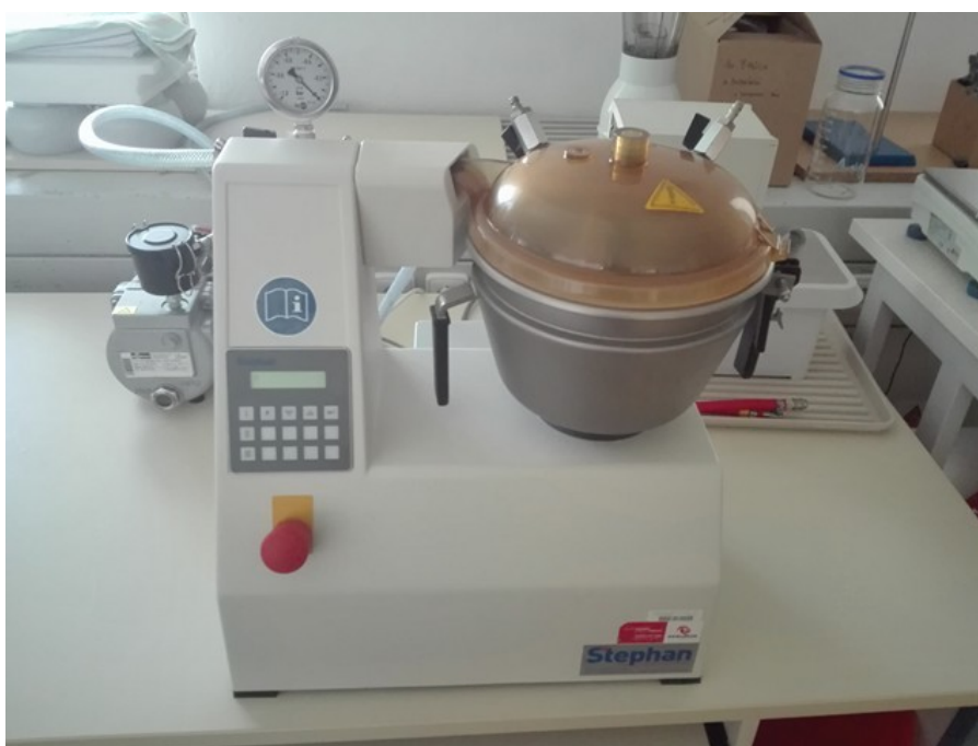
Obr. 3: Zařízení Stephan UMC-5 (Stephan Machinery GmbH, Halmen, Německo), které bylo použito při výrobě modelových vzorků tavených sýrů [foto autor práce].
