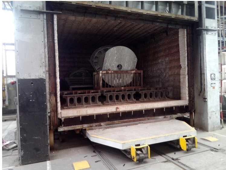
Obrázek 11 Naložená pec připravená k žíhání (vlastní zpracování)
