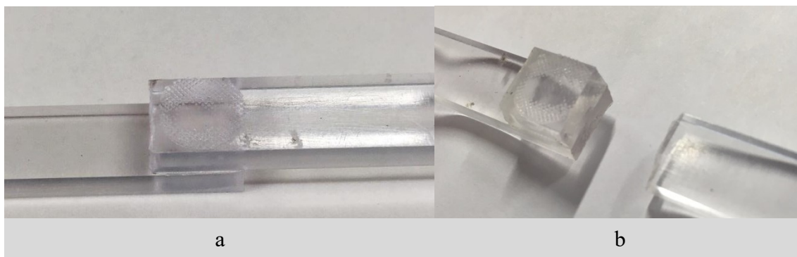
Obr. 40. Přeplátovaný svar polymeru PMMA svařeného energií 15 J
