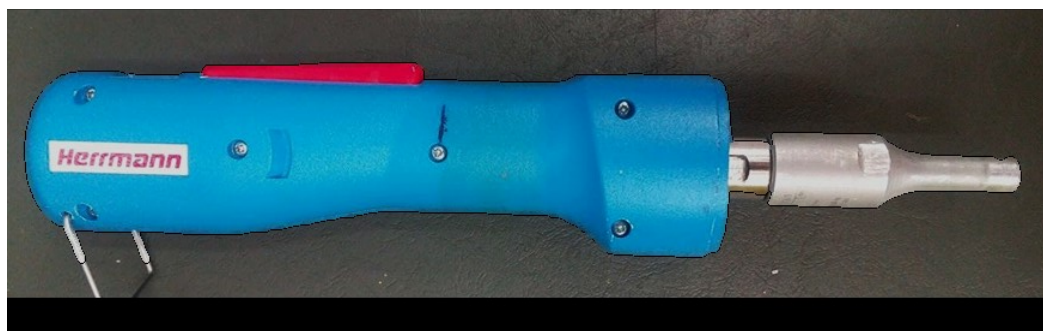
Obr. 28. Ruční ultrazvukové zařízení Herrmann HSG osazené svařovací sonotrodou
