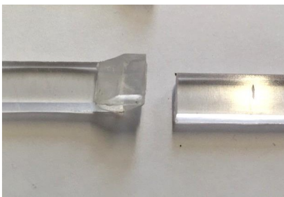
Obr. 42. Zkosný přeplátovaný svar polymeru PMMA svařeného energií 25 J
