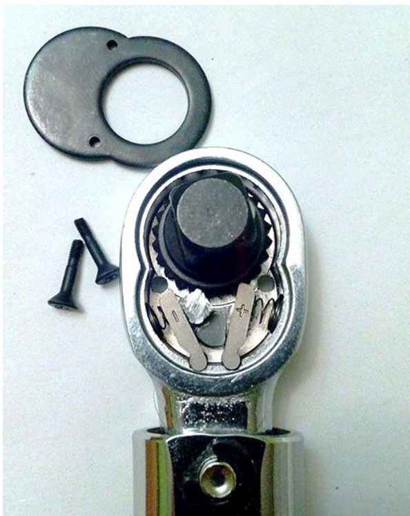
Obr. 23. Úprava momentového klíče
