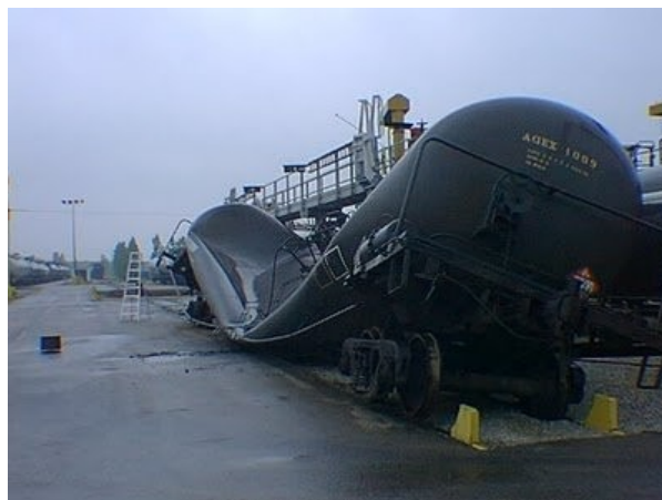
Obr. 18. Zborcení železniční cisterny [6]
