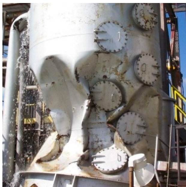
Obr. 17. Selhání nádoby vnějším přetlakem [6]
