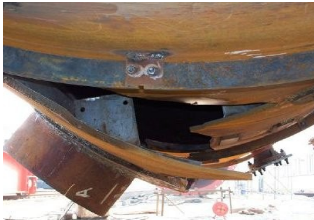
Obr. 16. Selhání nádoby vnitřním přetlakem [6]
