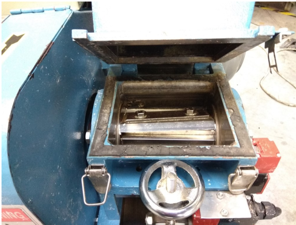
Obrázek 14: Laboratorní nožový mlýn
