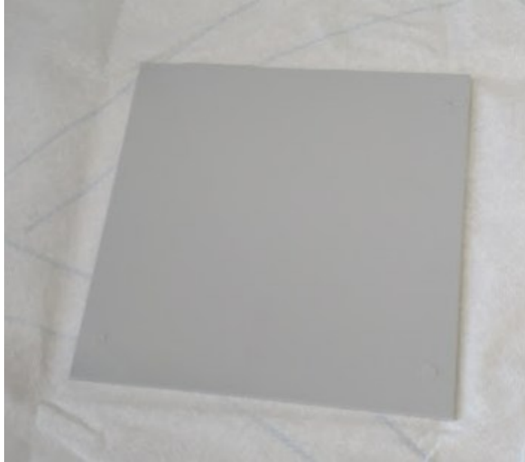
Obrázek 15: Zkušební těleso pro měření lesku
