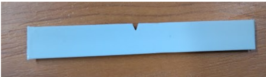
Obrázek 17: Zkušební tělíska pro zkoušku vrubové houževnatosti
