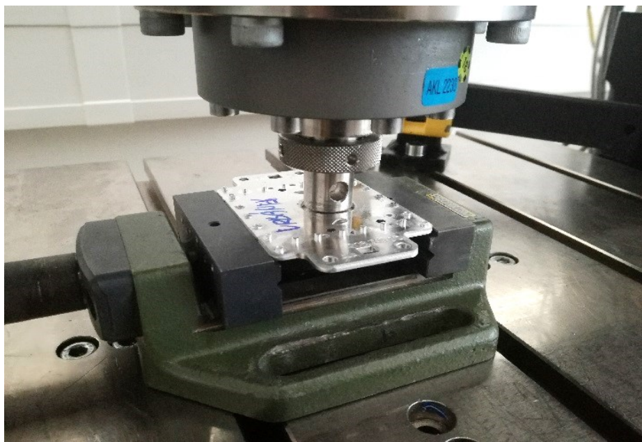
Obr. 21. Detail upnutí vzorku v přípravku.
