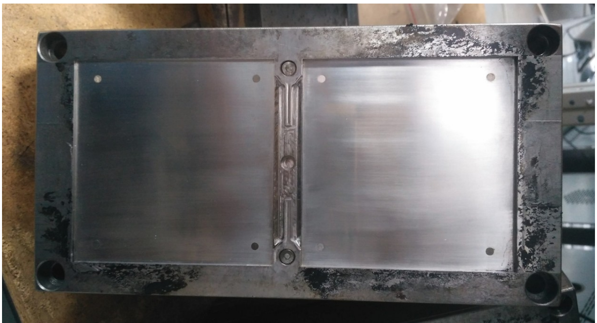
Obr. 17 Dvojnásobná forma pro vstřikování s kvádrovým tvarem dutiny. [vlastní zdroj]
