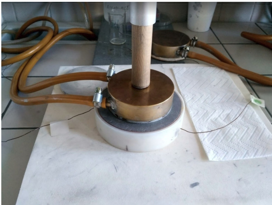
Obr. 27 Měření tepelné vodivosti na přístroji dle Fitch. [vlastní zdroj]
