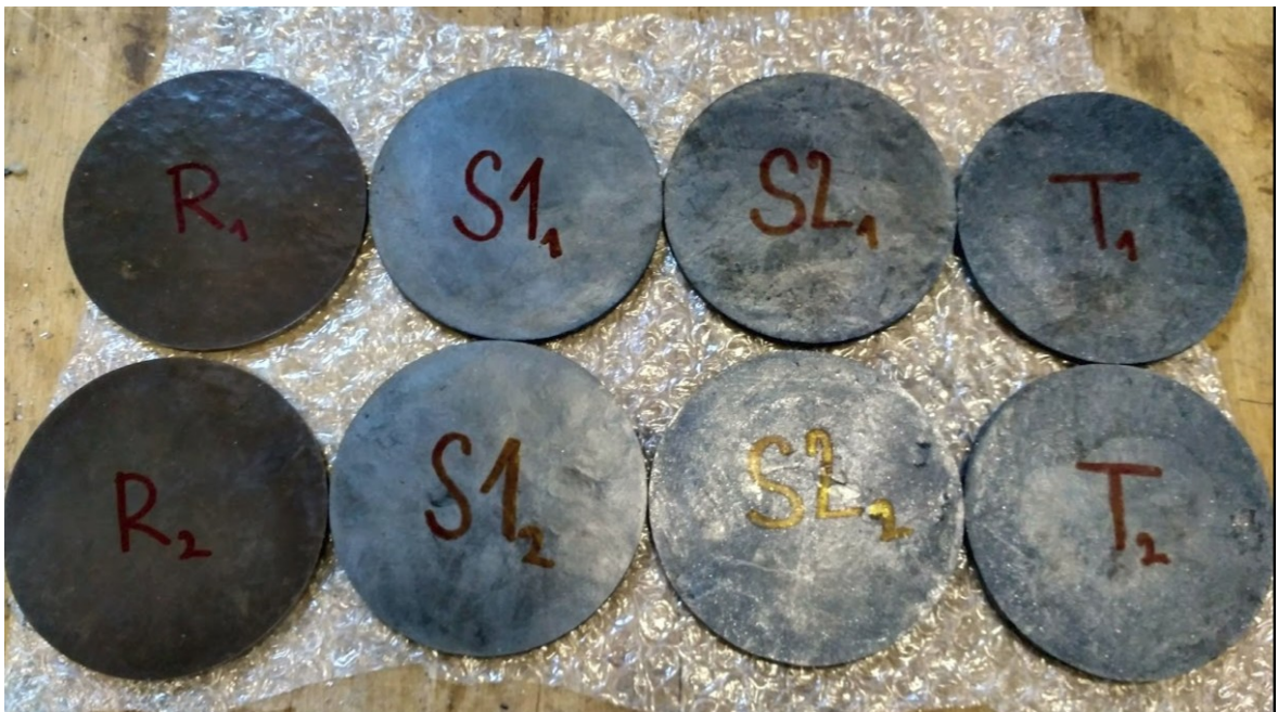
Obr. 15 Vylisované vzorky určené pro měření tepelné vodivosti. [vlastní zdroj]
