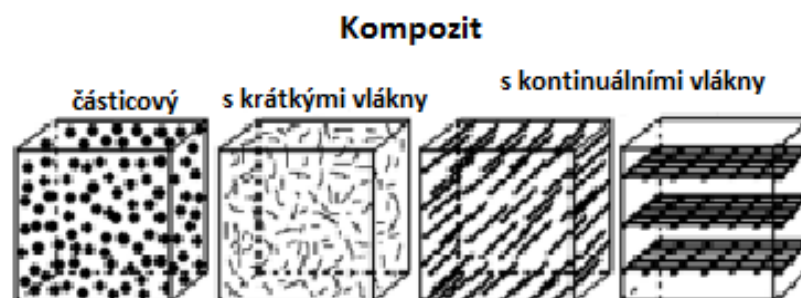
Obr. 5 Rozdělení kompozitních materiálů podle geometrického tvaru plniva. [26]
