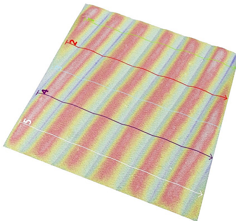
Obrázek 52. SEM snímek (3D rekonstrukce drsnosti povrchu): PLA, Original Prusa i3 MK3, vertikální tisk; R_z (22,23 \pm 0,60 \mu\text{m}) , R_a (5,93 \pm 0,21 \mu\text{m}) , S_a 5,74 \mu\text{m}
