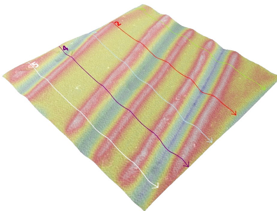
Obrázek 66. SEM snímek (3D rekonstrukce drsnosti): PLA, Ultimaker 2+, horizontální tisk (spodní strana); R_z (27,24 \pm 1,41 \mu\text{m}) , R_a (7,02 \pm 0,13 \mu\text{m}) , S_a 6,97 \mu\text{m}
