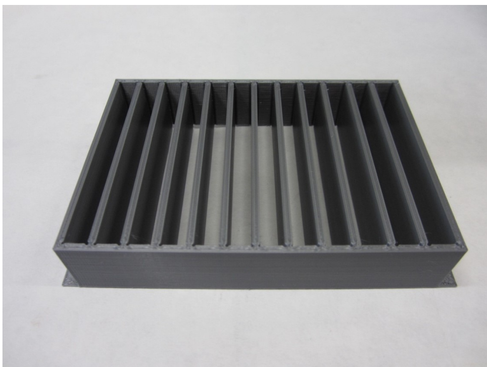
Obrázek 27. Reálná fotografie vzorku – vertikální typ tisku
