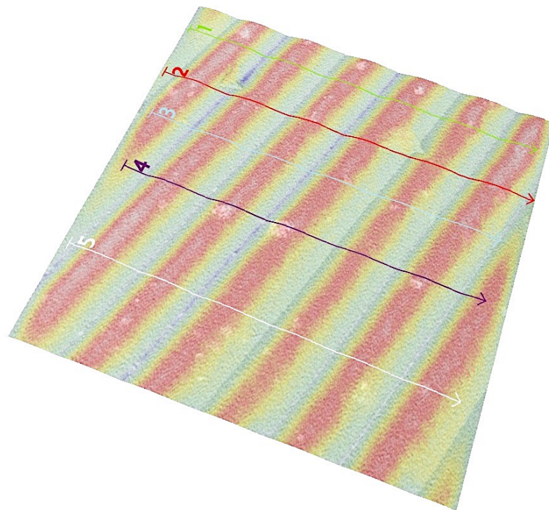
Obrázek 96. SEM snímek (3D rekonstrukce drsnosti): pro ABS, Original Prusa i3 MK3, vertikální tisk; R_z ( 14,28 \pm 0,14 \mu\text{m} ), R_a ( 3,83 \pm 0,06 \mu\text{m} ), S_a 3,73 \mu\text{m}
