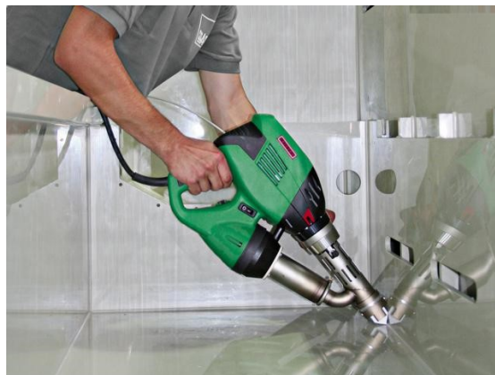
Obr. 7. Ruční svařování extruderem [7]
