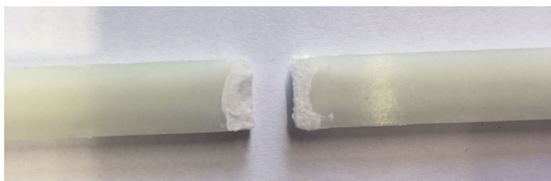
Obr. 60. Přetržený vzorek: PP 30 % GF, Varianta A
