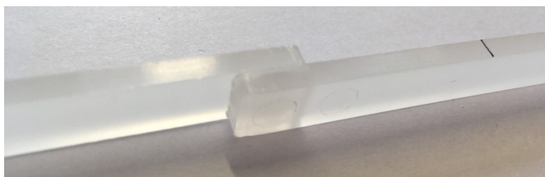
Obr. 51. Svařený vzorek: PP, Varianta B
