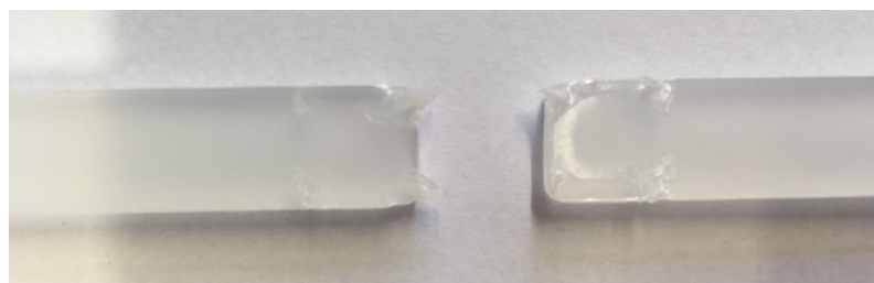
Obr. 52. Přetržený vzorek: PP, Varianta B
