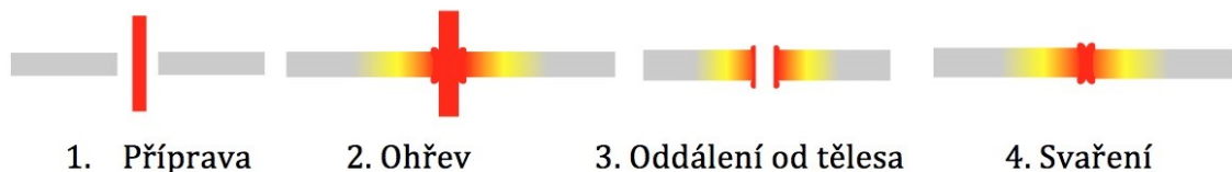
Obr. 3. Postup svařování horkým tělesem [7]
