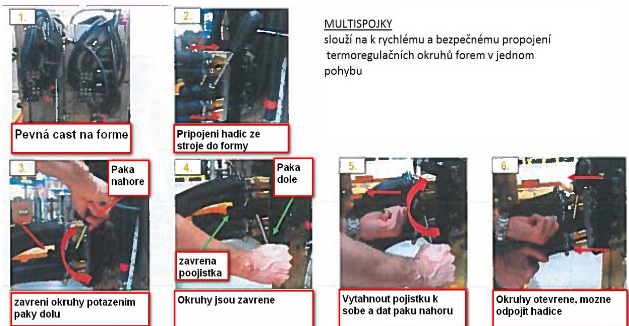
Obr. 24 Postup zavedení multispojek (Interní materiály společnosti)
