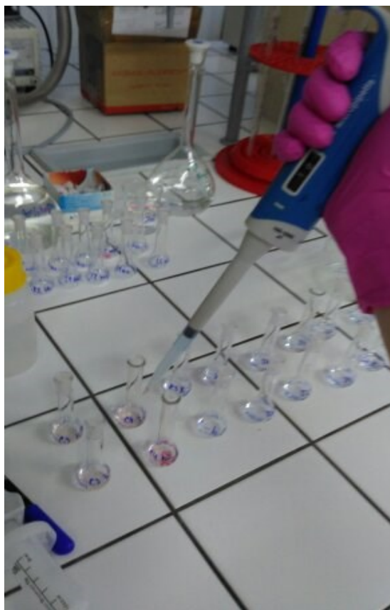
Obr. 8: Příprava roztoků pro měření absorbance
