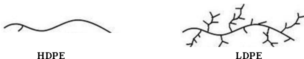
Obrázek 6. Struktura větvení HD-PE a LD-PE [11]
