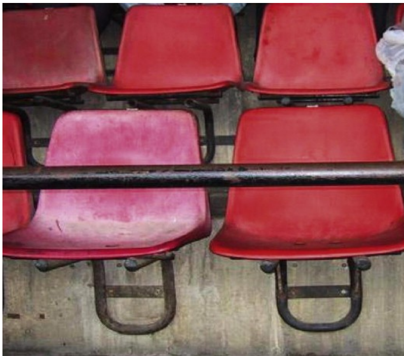
Obrázek 15. PP sedadla na stadionu vytavené dlouhodobému působení slunečního záření mohou vykazovat známky bělení. [36]
