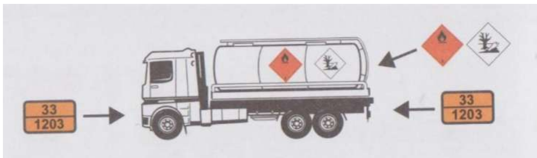
Obrázek 4: Označení cisterny přepravující jeden druh nebezpečné věci. Zdroj: [3].
