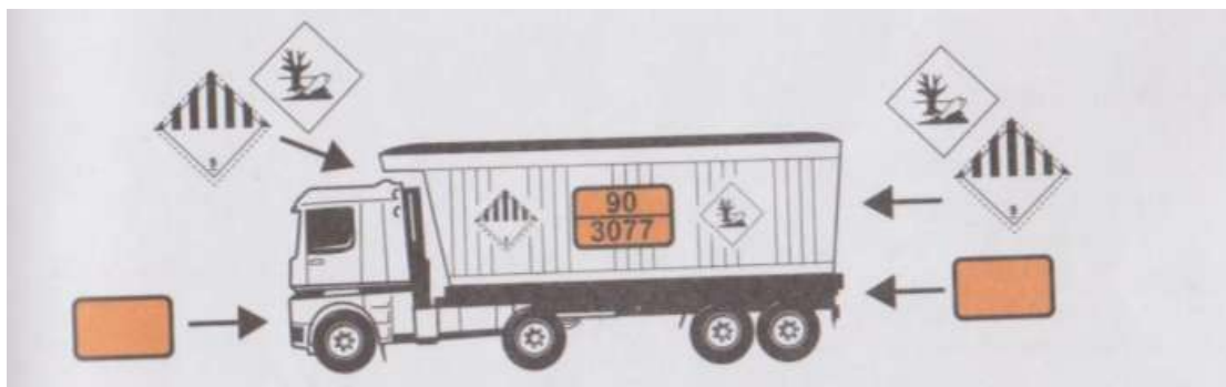
Obrázek 3: Označení kontejneru přepravujícího volně ložené nebezpečné věci Zdroj: [3].
