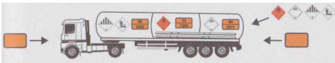
Obrázek 5: Označení cisterny přepravující více druhů nebezpečných věcí. Zdroj: [3].
