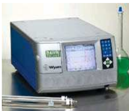
Obr. 5. Detektor mnohoúhlového rozptylu světla (výrobce Bioscience Technology)
