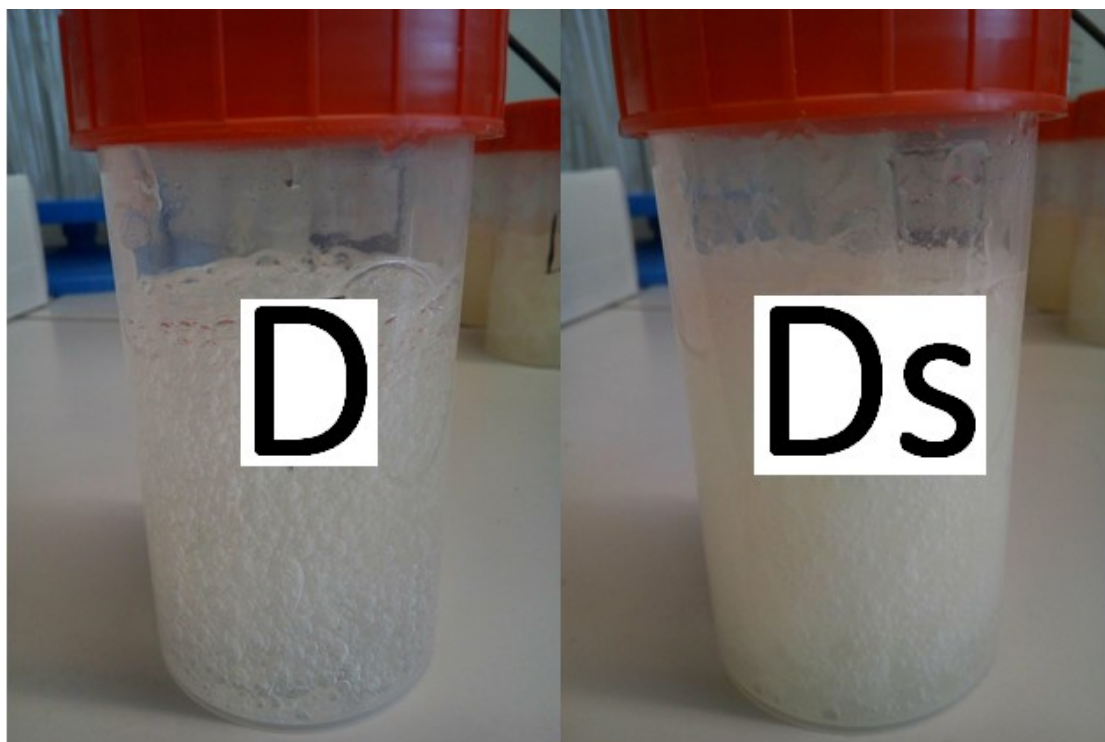
Obrázek 17 Hydrogel na bázi hydroxypropyl methylcelulózy připravený ve vodě (vlevo) a v syrovátkovém roztoku (vpravo). [vlastní]
