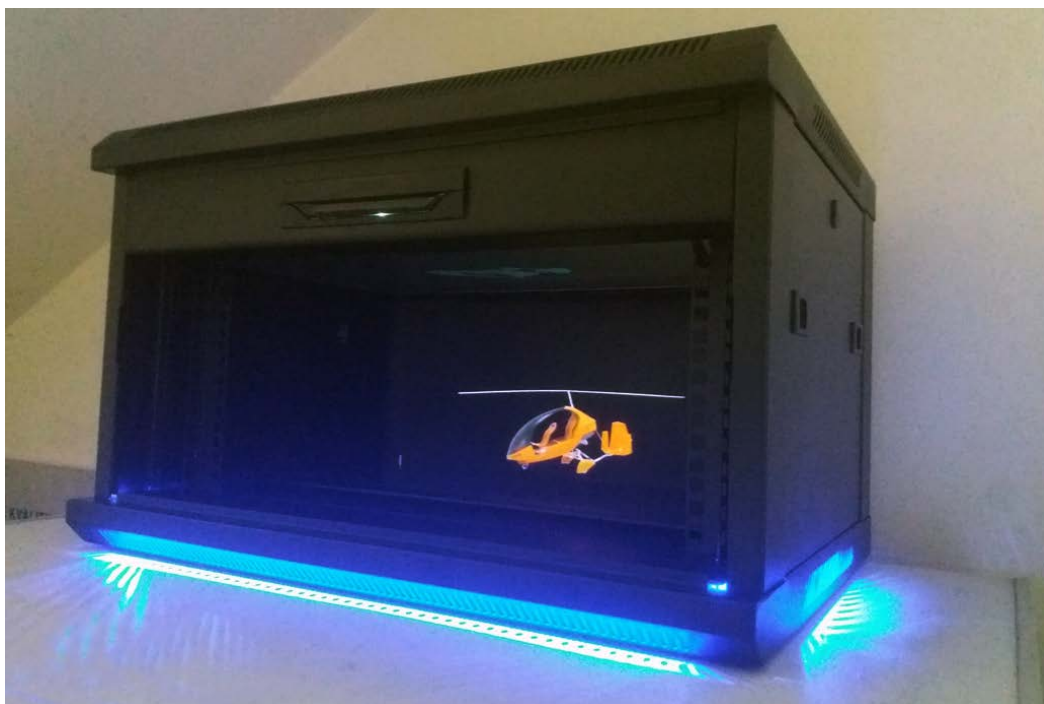
Obr. 111: Finálne riešenie vizualizačného zariadenia – pseudo - holografická projekcia č. 2
