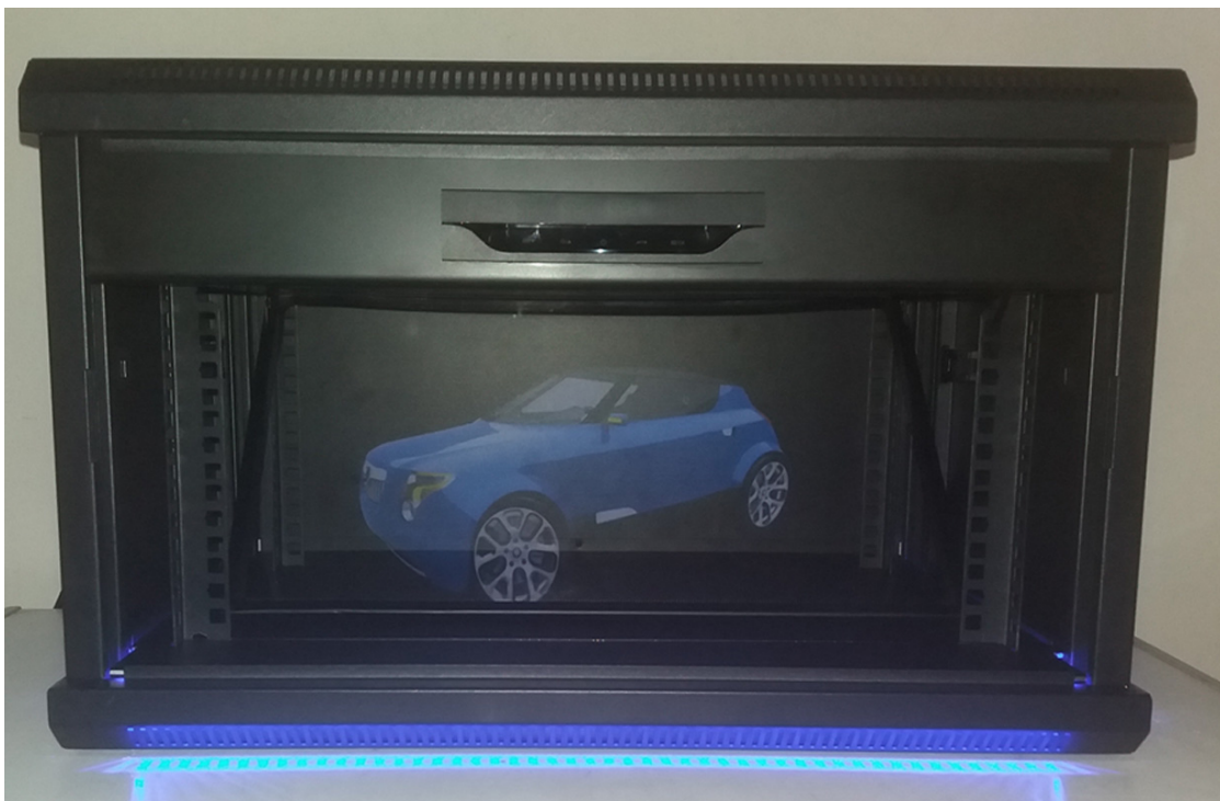
Obr. 110: Finálne riešenie vizualizačného zariadenia – pseudo - holografická projekcia
