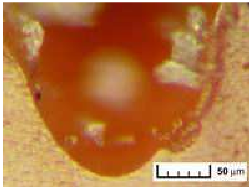
Obr. 43. Ukázka gaussovské distribuce tvaru drážky. Materiál ABS (13)
