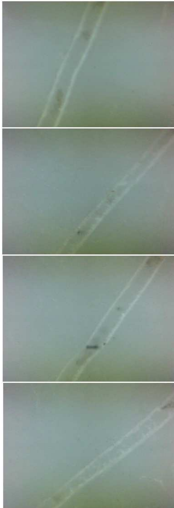
Obr. 47. Snímky drážek u PTFE, vytvořené při následujících parametrech obrábění:
