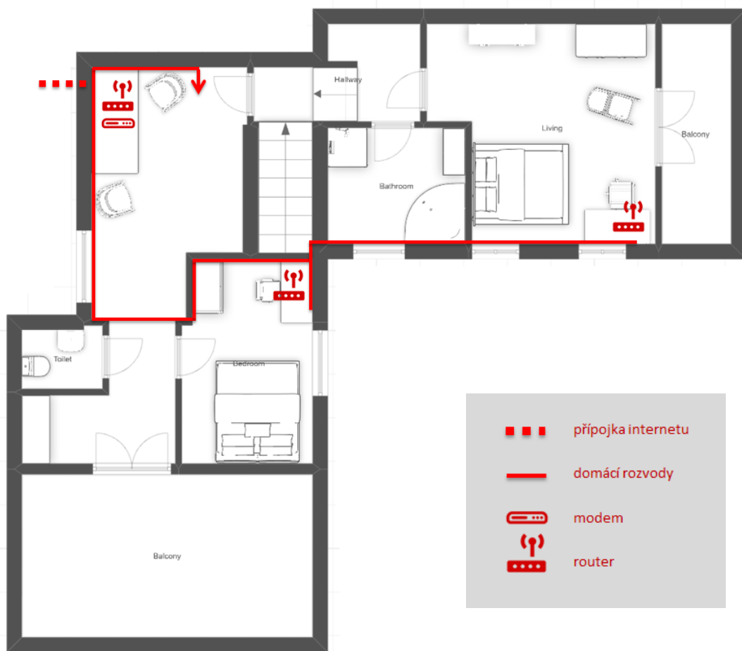
Obrázek 22: Navrhované řešení internetového připojení v domě – 2 NP [zdroj: autor]
