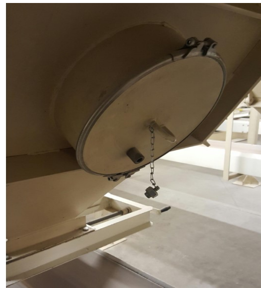
Obrázek 7 - Spodní část sila, výfuk na přebytečný plyn ze sila
