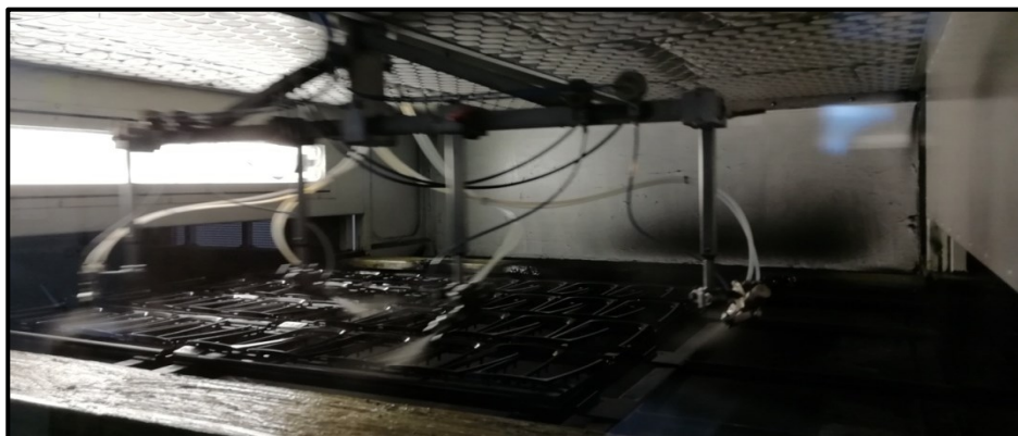
Obrázek 46: Foto lakování 263 – stříkání pistolí (interní zdroje)
