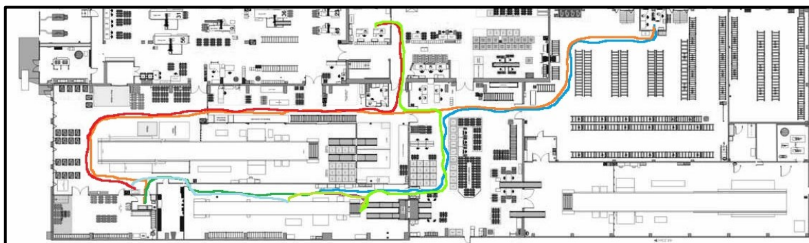
Obrázek 52: Spaghetti diagram pohybu lakaře při přestavbě lakovací linky 1
