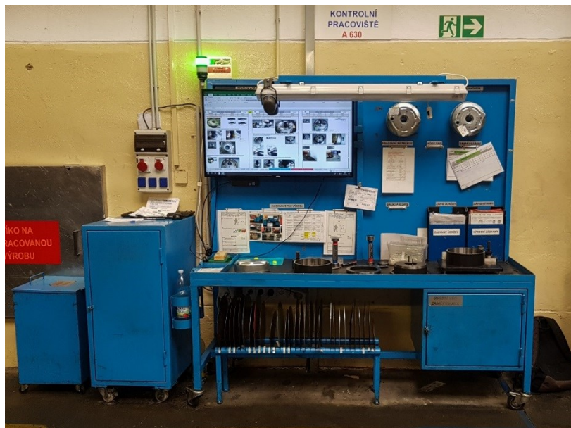
Obr. 22. Kontrolní pracoviště stroje Arisa 630 (vlastní zpracování, 2019)
