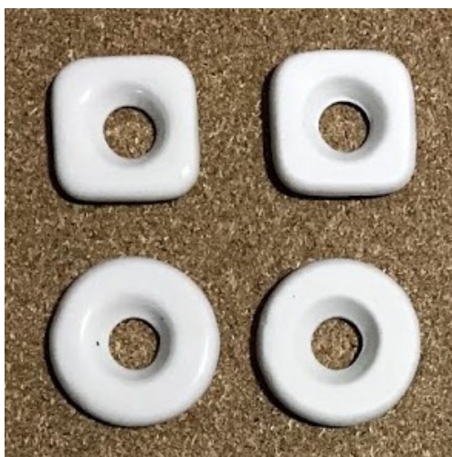
Obr. č. 65 Vlevo – transparentní glazura, vpravo – porcelán bez glazury
