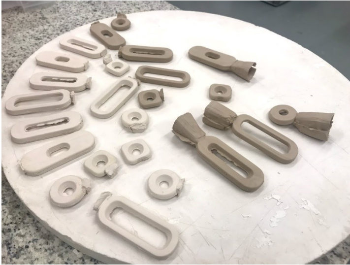
Obr. č. 64 Světlé suché odlitky a tmavé vlhké, vyjmuté z formy
