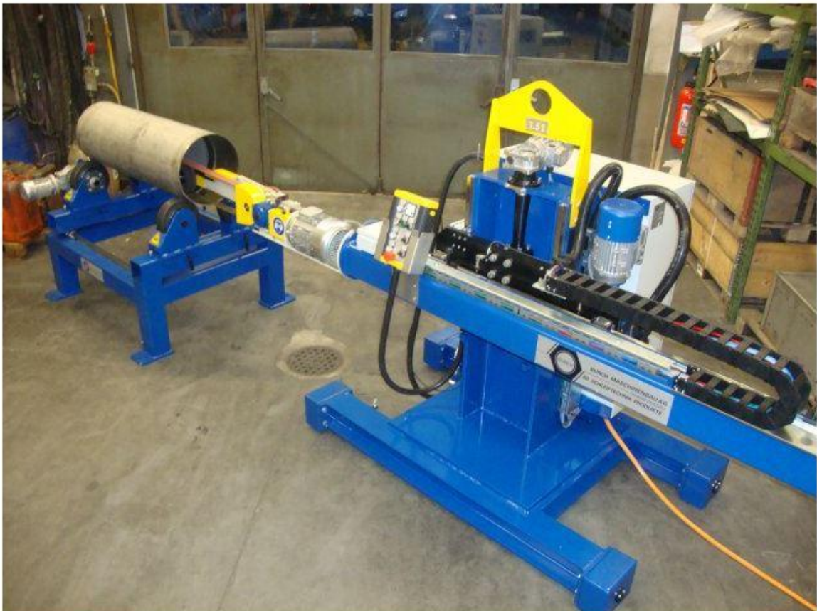
Obr. 2 Broušení pásem, osa válce je rovnoběžná s osou pásu, pro malé průměry.
