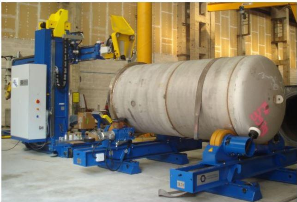
Obr. 3 Broušení pásem na větších průměrech, osa válce je kolmá na osu pásu.
