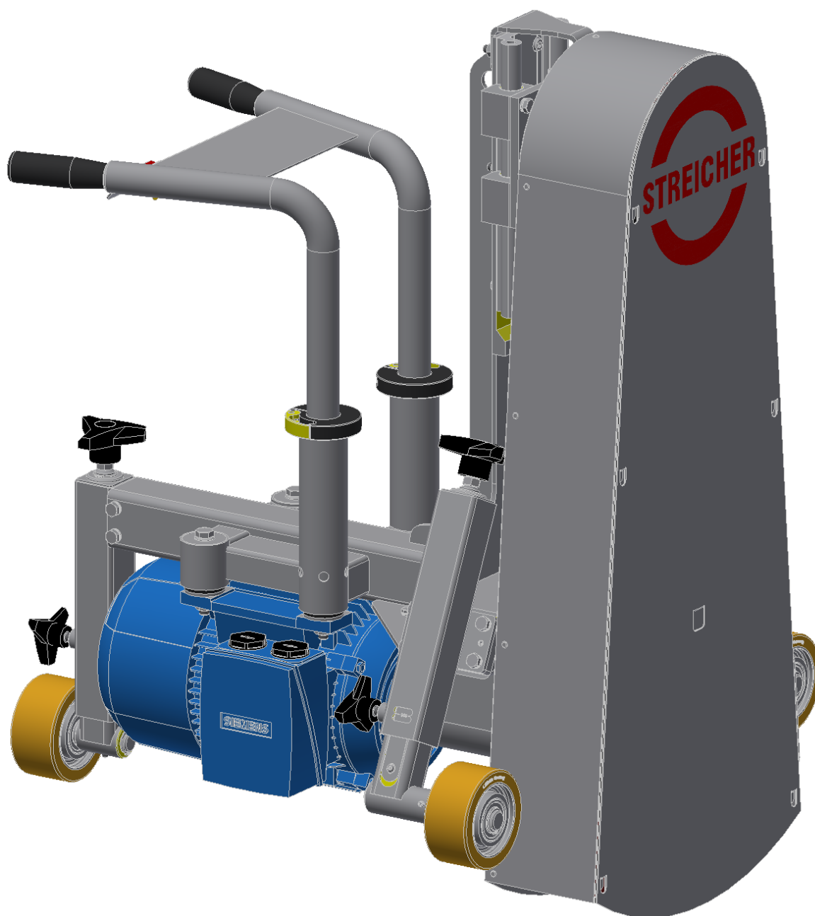
Obr. 76 Sestava brusného stroje s ochrannými kryty – přední pohled.
