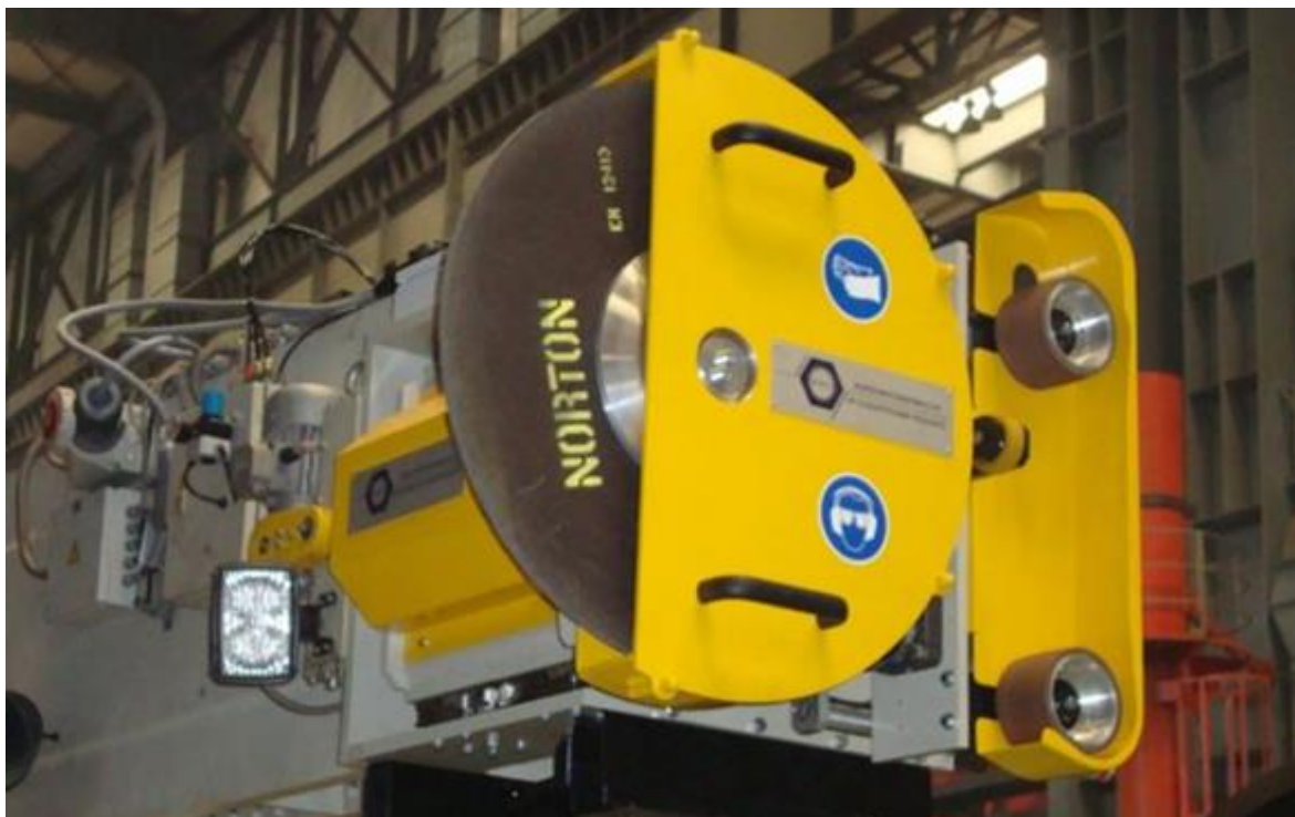
Obr. 11 Stroj na úkosování před svařením pláště.
