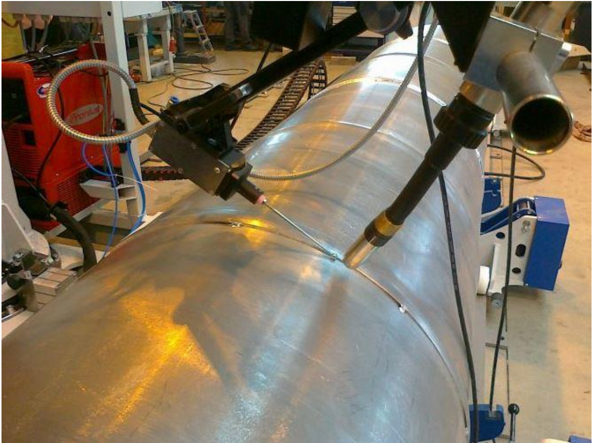
Obr. 30 Elektromechanické dotykové čidlo na měření.
