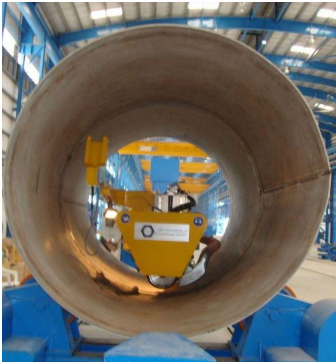
Obr. 8 Střechovitost u válce po svaření pláště.
