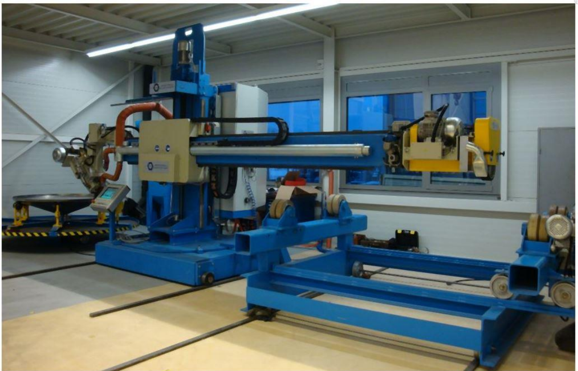
Obr. 14 Stroj s výsuvným ramenem v ose válce.
