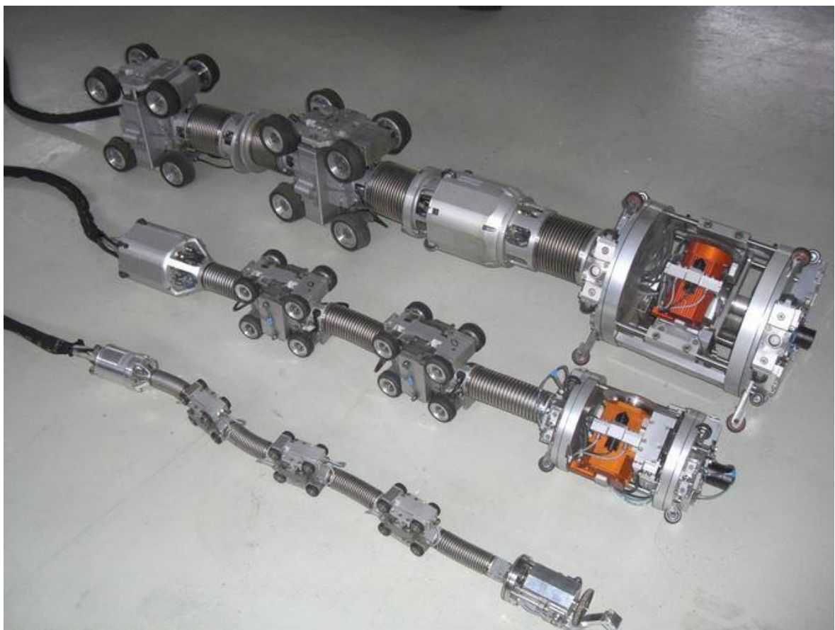
Obr. 20 Brusné roboty od průměru 80 mm do 200 mm.
