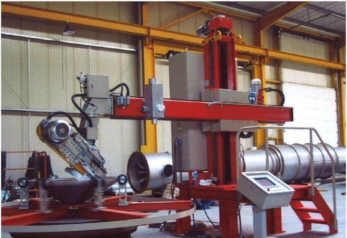
Obr. 15 Broušení rotující bombírované příruby.
