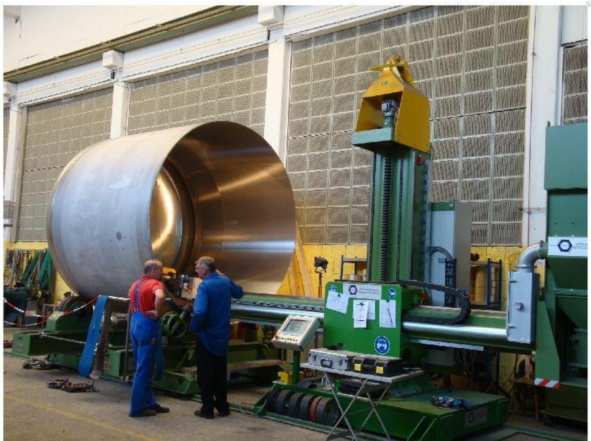
Obr. 16 Klasické vnitřní broušení s rotací po vnějším plášti.
