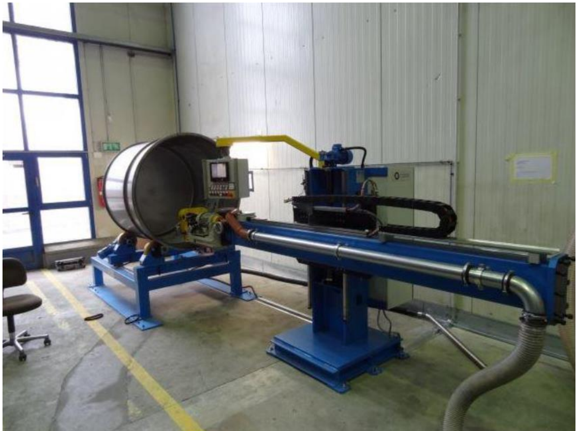
Obr. 4 Volba brousícího stroje podle velikosti válce.
