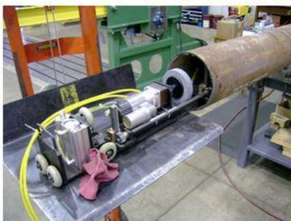
Obr. 22 Koncept částečně ručního broušení trubek.
