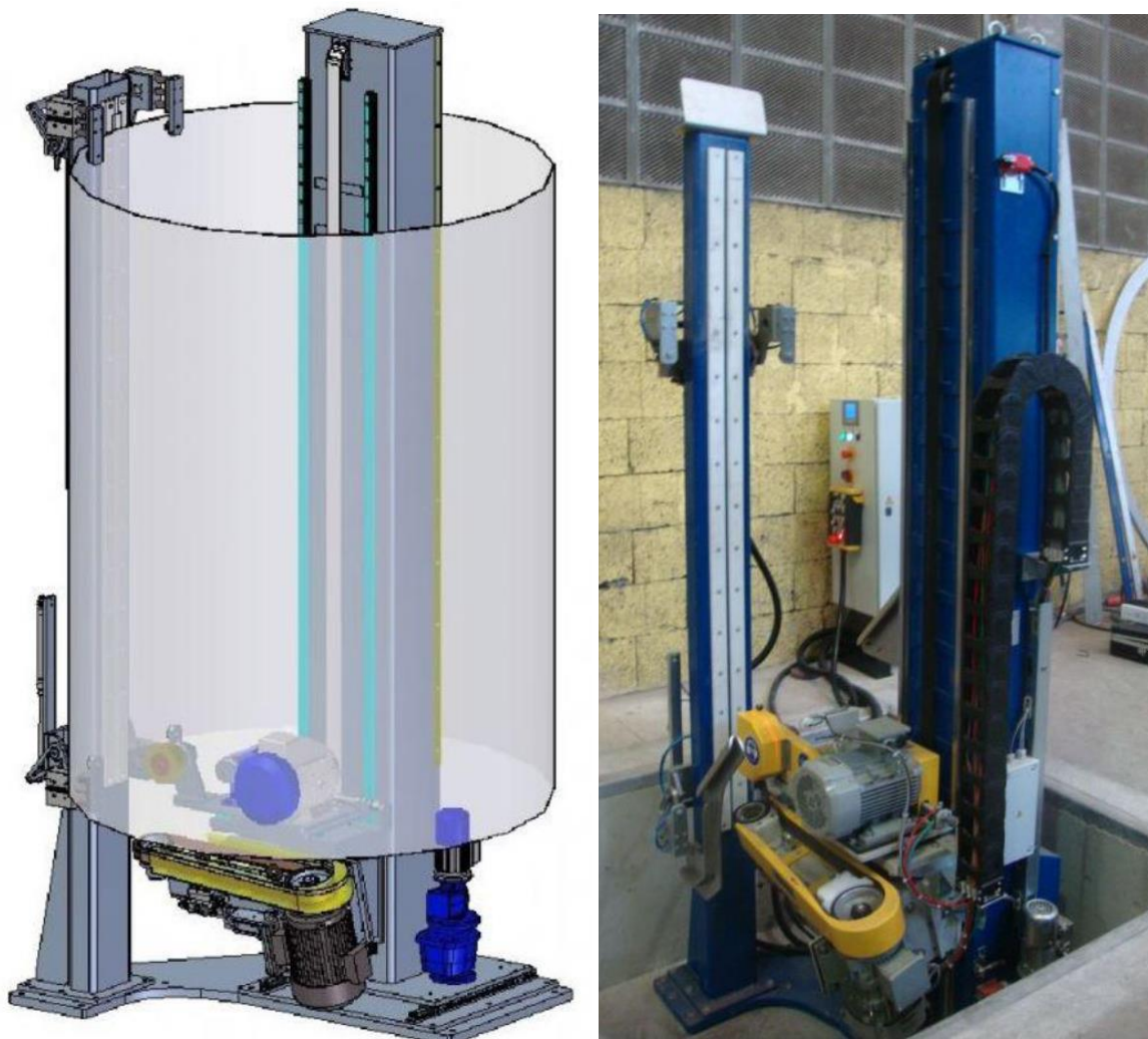
Obr. 6 Broušení pásem, stroj ve vertikální poloze (3D model a skutečný stroj).
