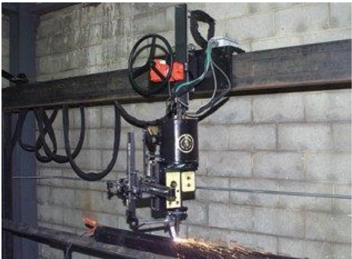
Obr. 27 Řešení pojezdů (zde pro svařovací robot, použitelného ale i pro broušení).
