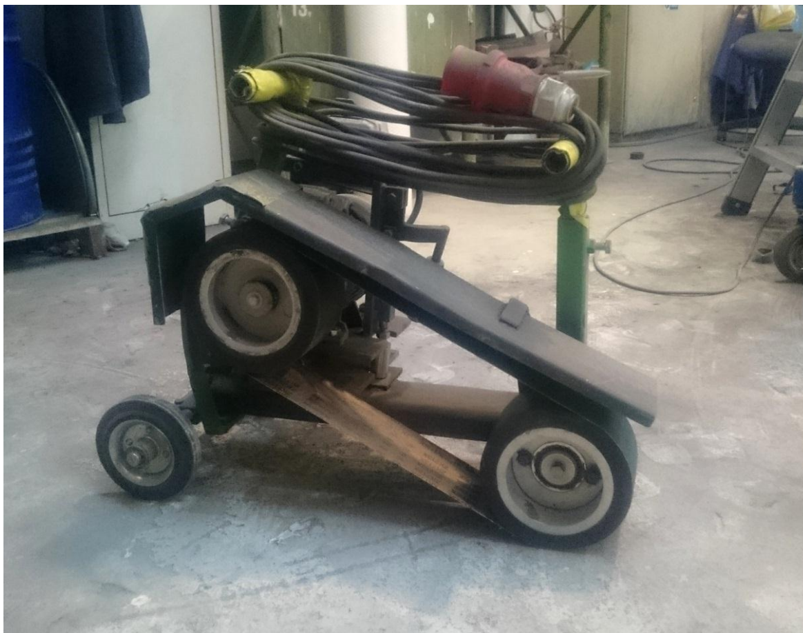
Obr. 31 brousící stroj "motorka" používaný ve firmě Streicher.
