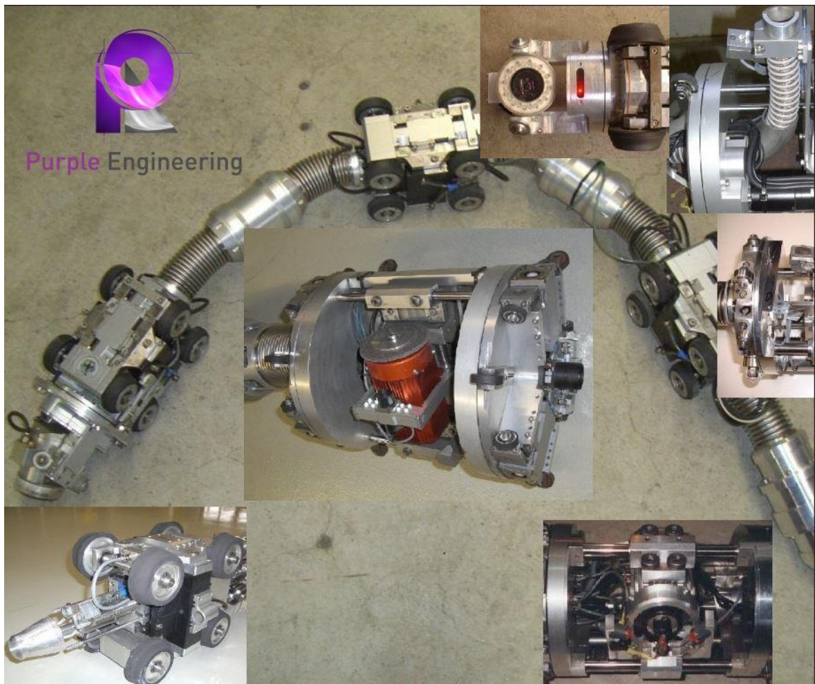
Obr. 17 Brusné roboty - celý skládací systém (měřicí, brousící, odsávací).
