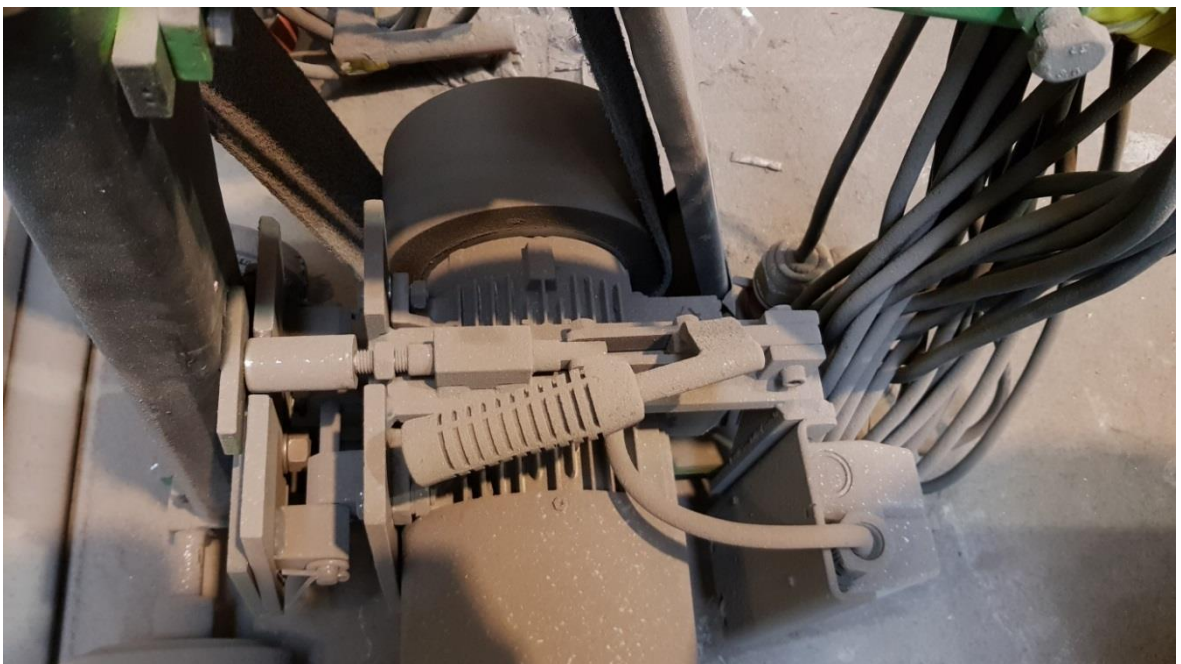
Obr. 52 Ruční napínák na traktorce ve firmě Streicher – pohled shora.
