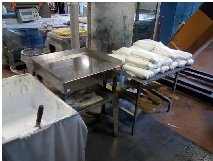
Obrázek 14 Navážené batche, připravené k použití na korečkový dopravník (vlastní zpracování)
