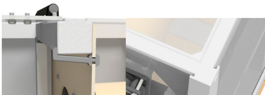
Obrázek 45 Upínka dělicí přepážky a úprava rámu pro upnutí krycích desek.
