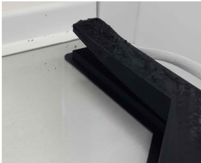
Obrázek 57 Deformace rámu při 3D tisku z materiálu ABS.
