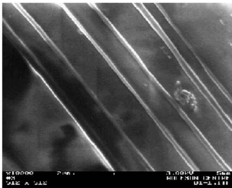
Obrázek 11. Uspořádání vláken z polymeru PEO na špičce kolektoru. [49]
