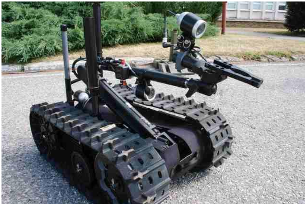
Obr. 6. Pyrotechnický robot, který je řazen mezi servisní roboty [8]
