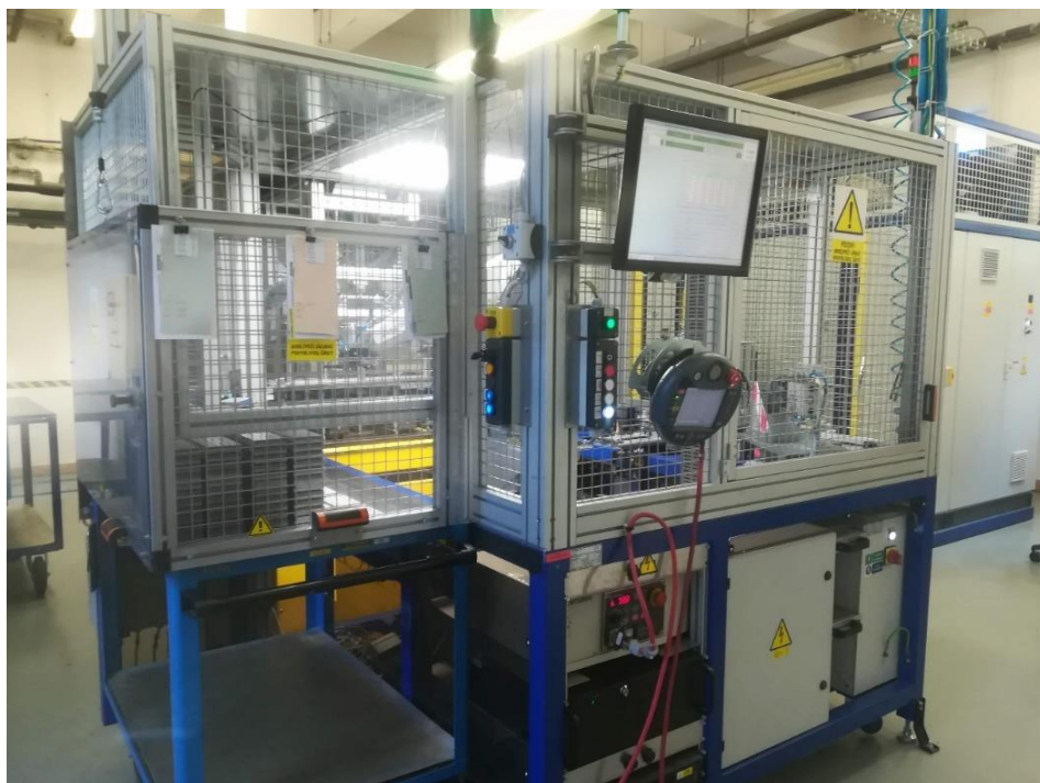
Obr. 21. Současný stroj kamerové kontroly
