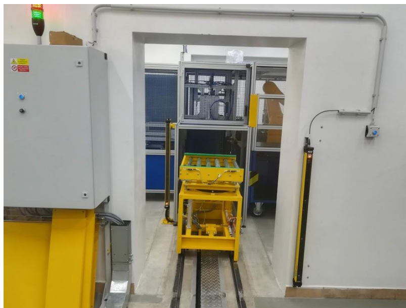
Obr. 38. Nová dopravníková dráha
