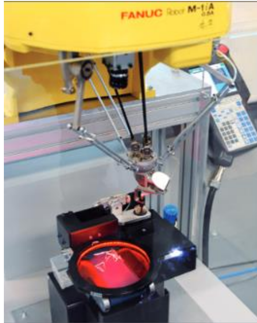
Obr. 3. Montáž drobných pinů do konektoru pomocí paralelního robota [10]
