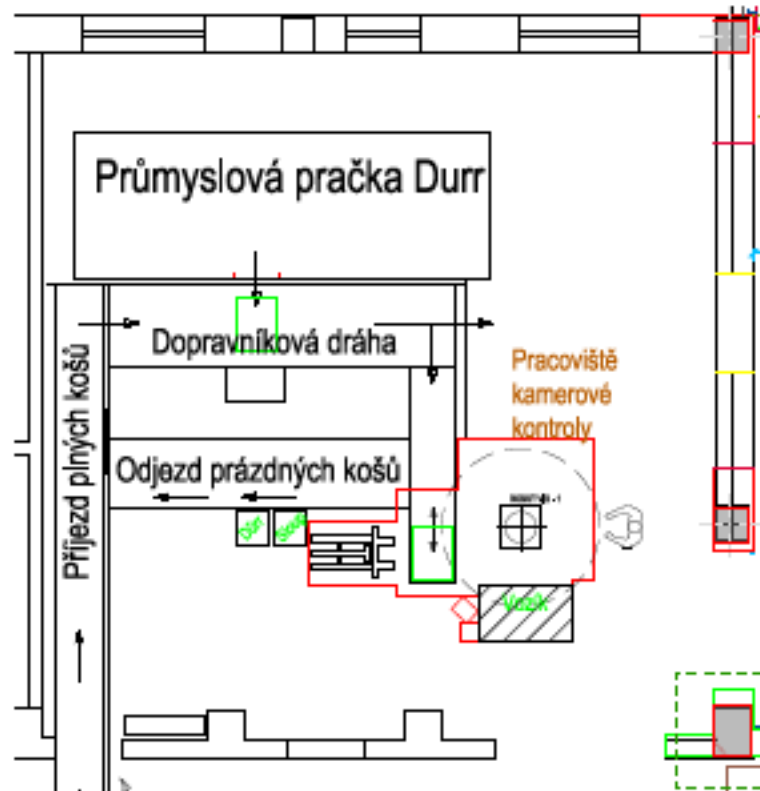
Obr. 20. Současný layout pracoviště; v levé části obrázku je vyznačen příjezd plných košů ke kontrole, které následně robot vyprázdní a prázdné koše odesílá zpět
