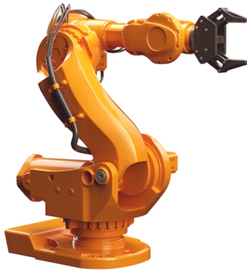
Obr. 10. Koncový efektor pro manipulaci a paletizaci [3]
