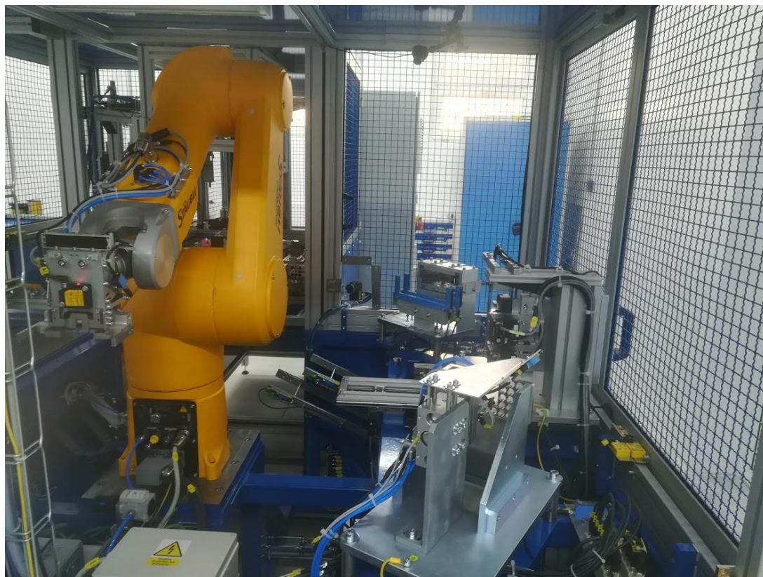
Obr. 27. Robot TX 90 instalovaný pro kamerovou kontrolu, v pravé části obrázku je možné vidět jednotlivé stanice – checker, dotlačení, kamerová kontrola a NOK stanice
