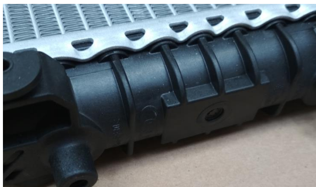
Obrázek 12 Víko pevně spojeno s komorou
