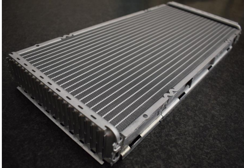
Obrázek 10 Zapájené hliníkové jádro bez rámu
