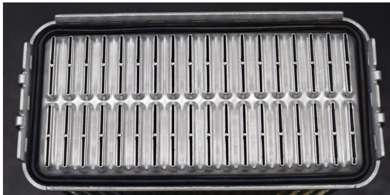
Obrázek 11 Těsnění volně vložené do víka
