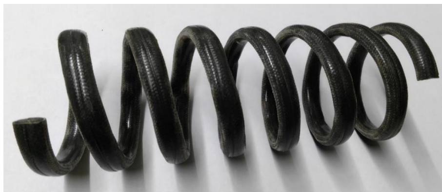
Obr. 13: Vinutá pružina využívající předimpregnovanou výztuž
