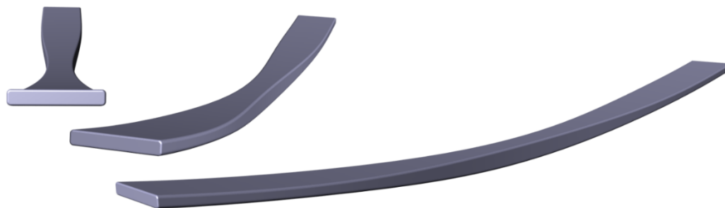
Obr. 17: Model pružného prvku s proměnlivou geometrií průřezu
