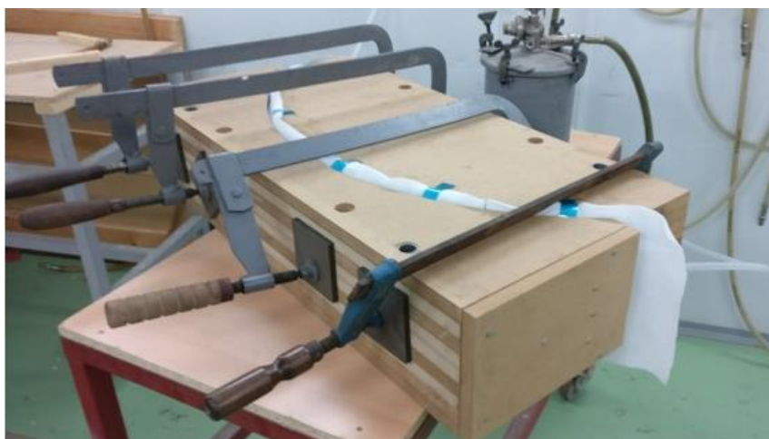
Obr. 15: Výroba listové pružiny
