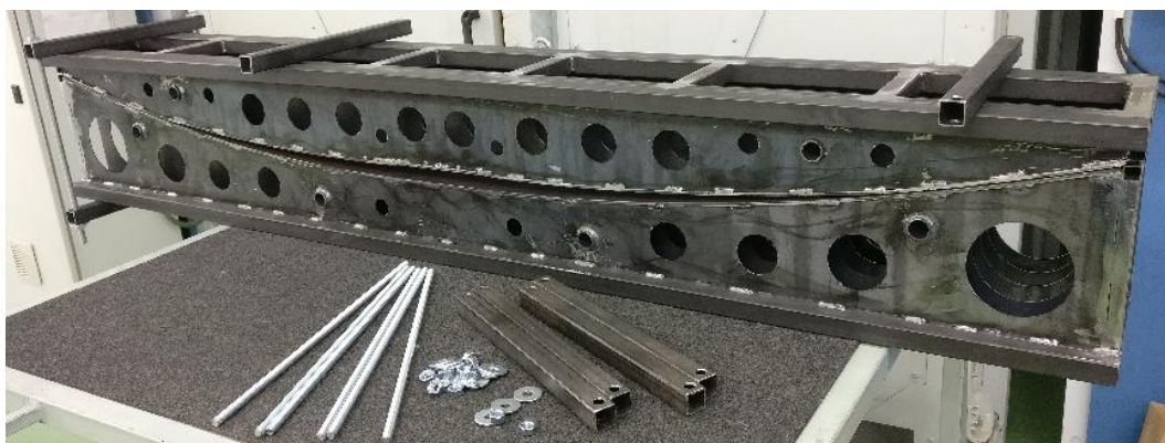
Obr. 16: Výrobní forma pro parabolickou pružinu
