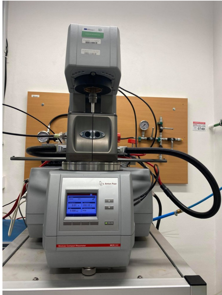
Obrázek 25: Použitý přístroj pro měření reologických vlastností
