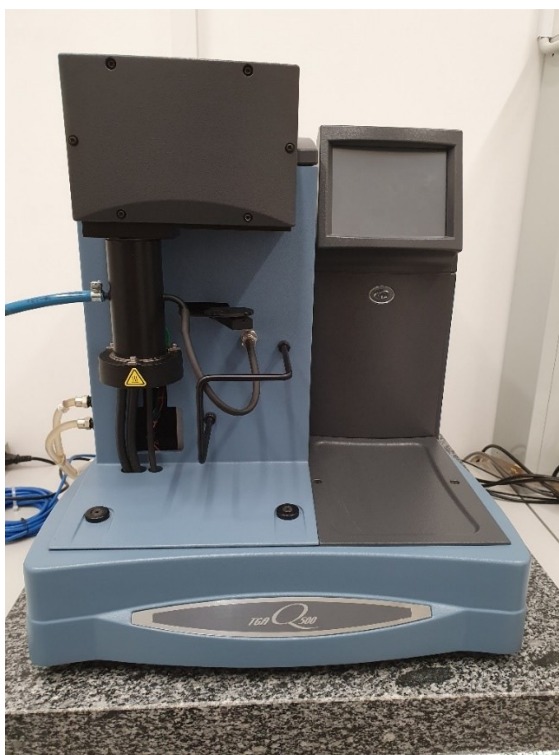
Obrázek 23: Použitý přístroj pro měření termogravimetrické analýzy
