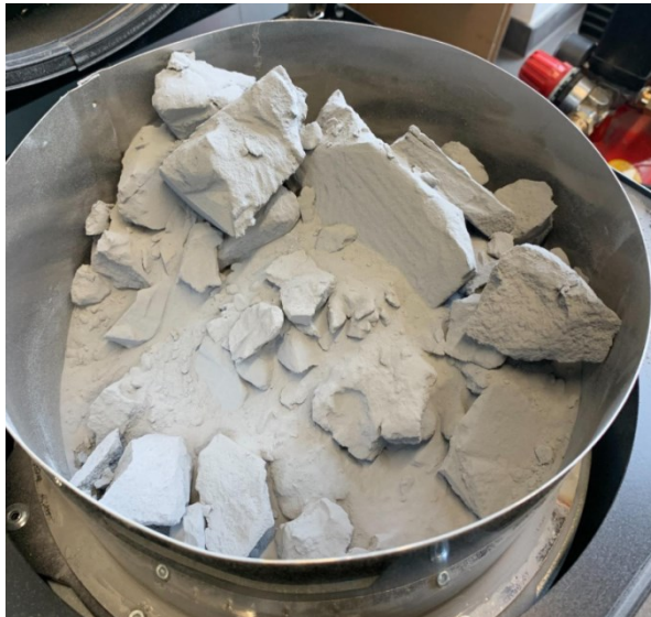
Obr. 51. Prášek polyamidu připravený k tisku
