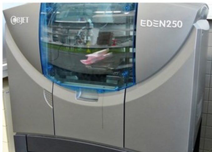
Obr. 53. 3D tiskárna Objet Eden 250
