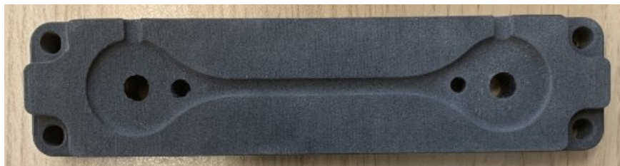
Obr. 52. Tvarová vložka vytisknutá pomocí SLS
