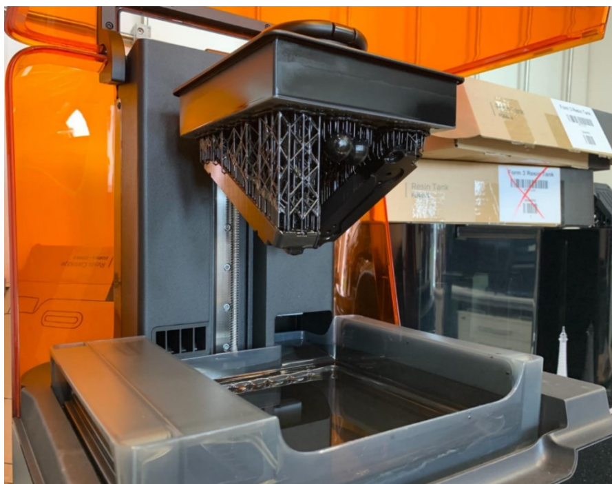
Obr. 47. Tisk technologií SLA
