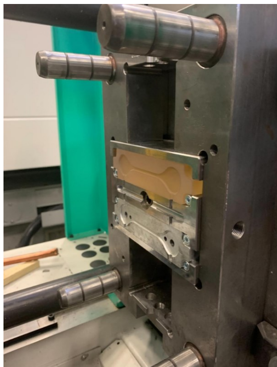
Obr. 65. Připevněné tvarové vložky do vstříkovací formy stroje
