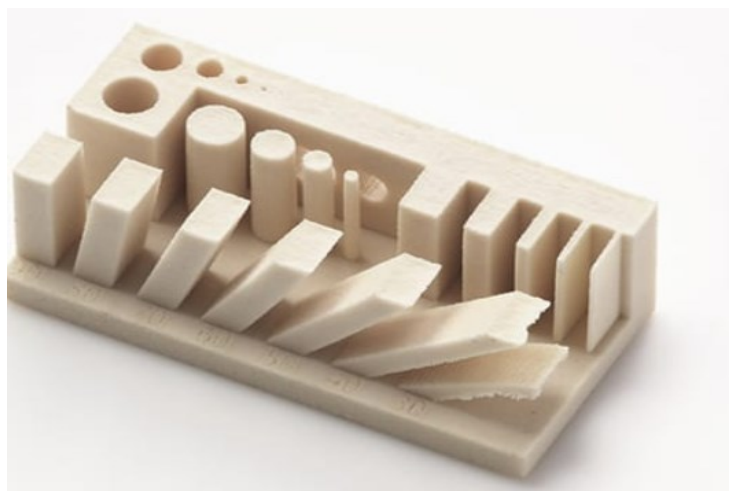
Obr. 9. Typické díly vyrobené pomocí metody SGC [13].
