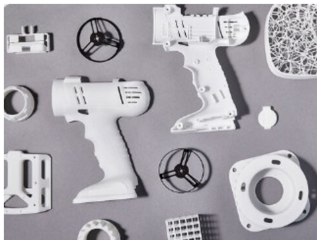
Obr. 11. Typické díly vyrobené pomocí metody SLS [16].
