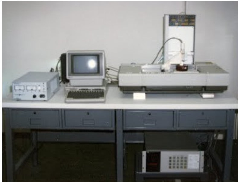
Obr. 4. Model první 3D tiskárny typu SLA – 1, zhotovená firmou 3D Systems [5]
