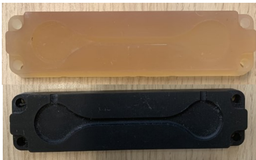
Obr. 48. Tvarové vložky vytisknuté pomocí SLA
