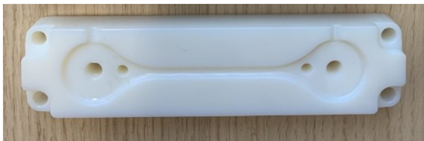
Obr. 54. Tvarová vložka vytisknutá pomocí Polyjet
