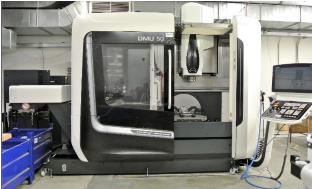
Obr. 63. CNC frézka s naklápěcím rotačním stolem DMG MORI DMU 50
