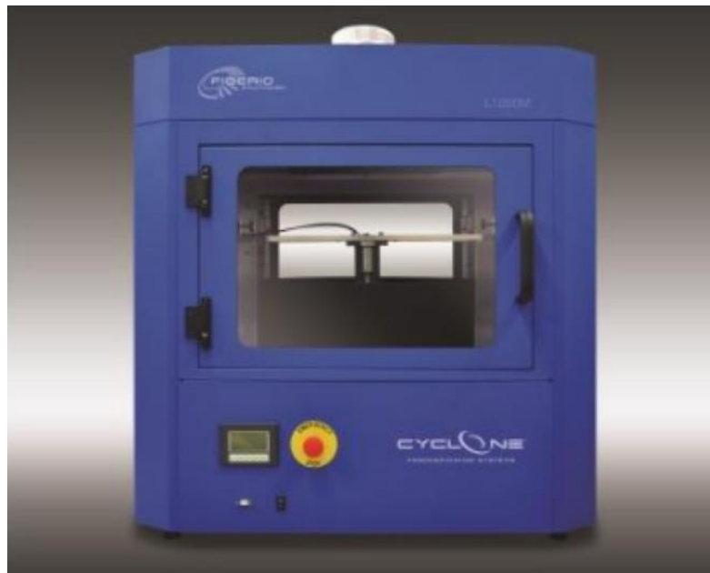
Obr. 7: Zařízení pro odstředivé zvlákňování od společnosti Fiberio (BLAŽKOVÁ, 2014)
