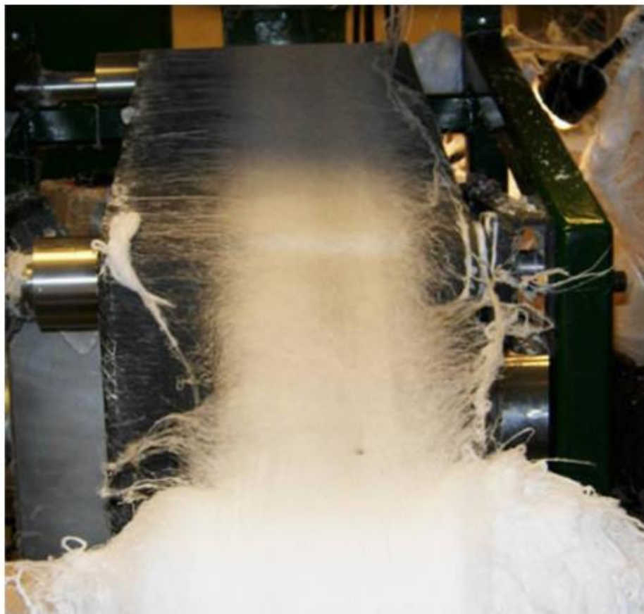
Obr. 2: Linka pro výrobu nanovláken rozfoukavacím postupem (SODOMKA, 2004)
