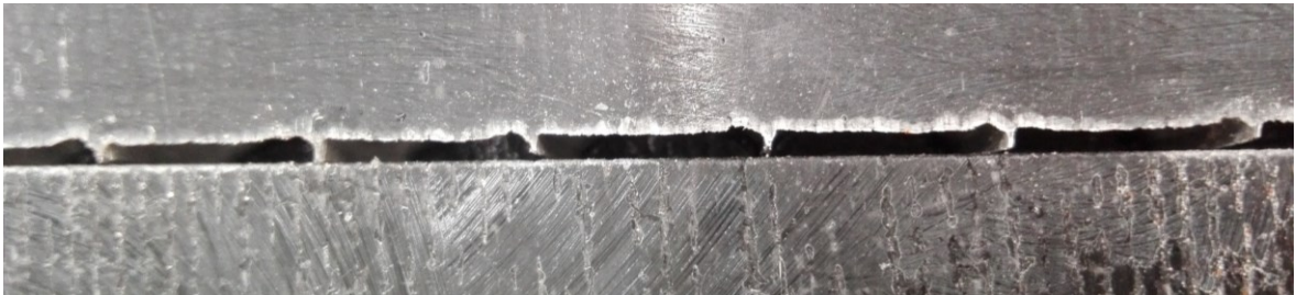
Obrázek 34: Podřezaná hrana spodního potahu sendviče po řezání vodním paprskem (nahore), jakostně lepší hrana horního potahu sendviče po řezání vodním paprskem (dole).
