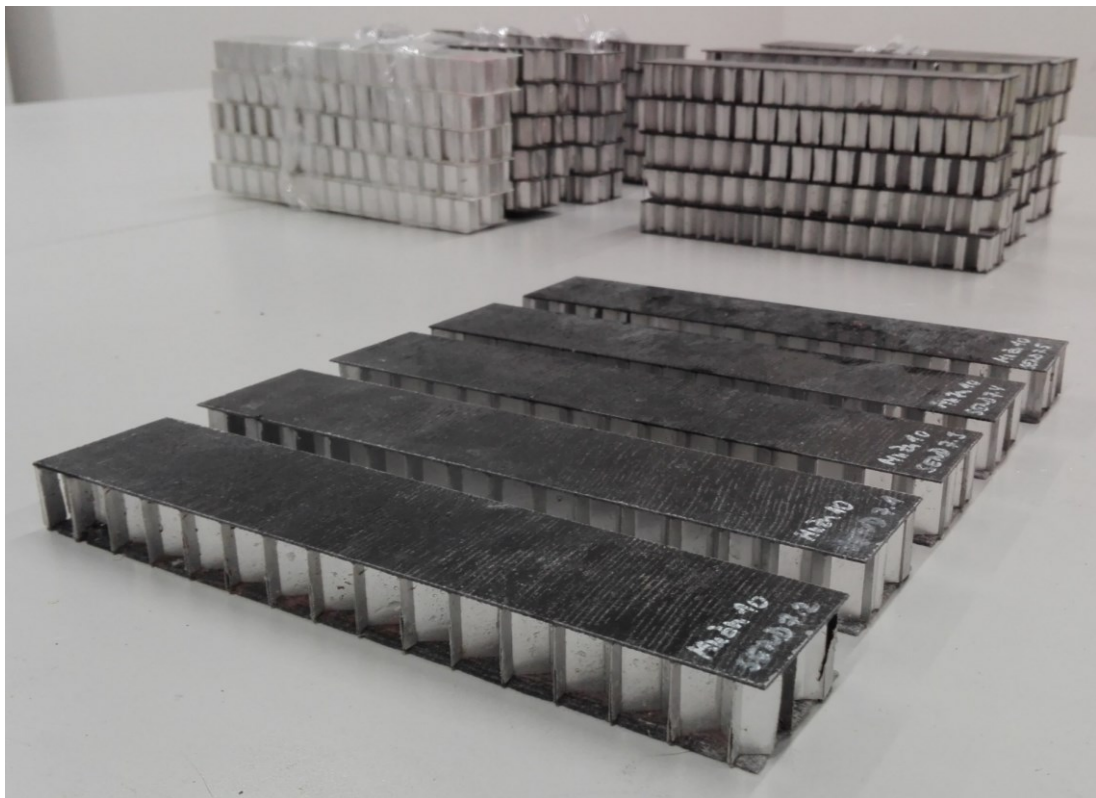
Obrázek 35: Zkušební tělesa nařezaná ze sendvičových panelů.
