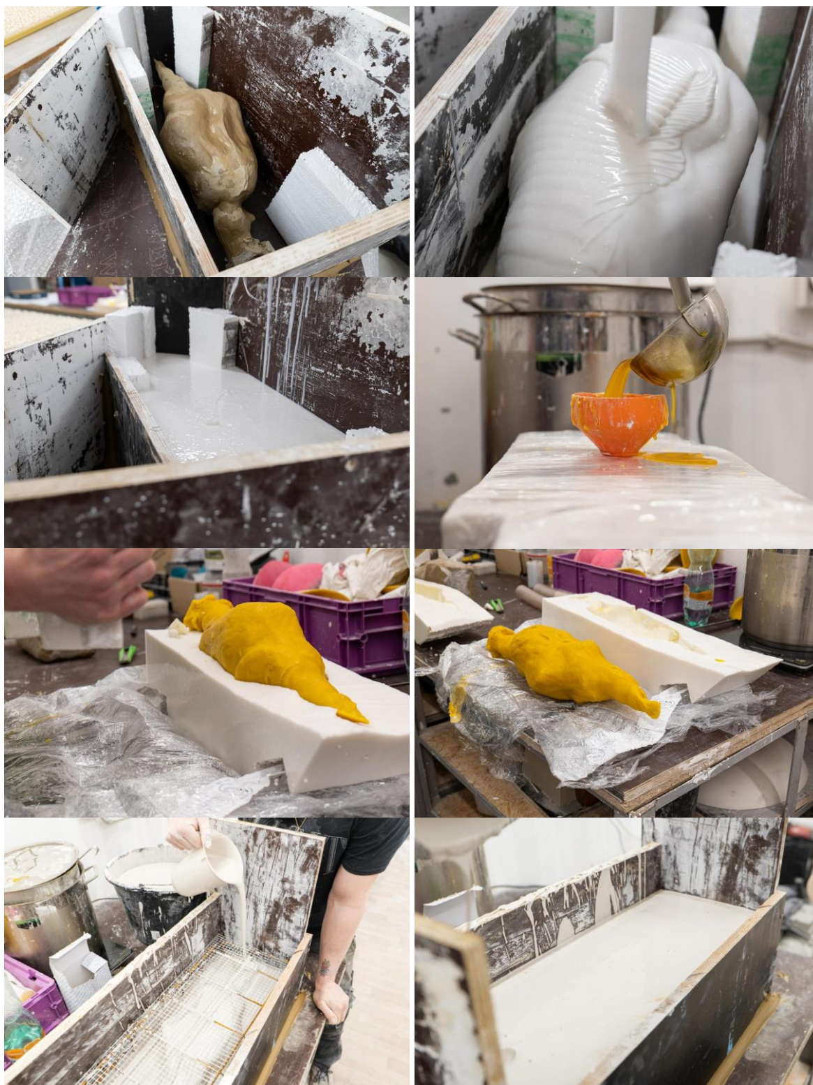
Obrázek 35 Výroba lukoprenové a sádrové formy
