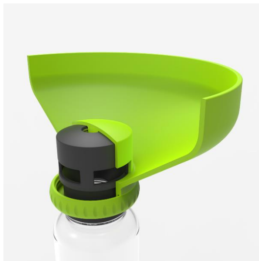
Obr. 14. Náhled v řezu stavu „ON“
