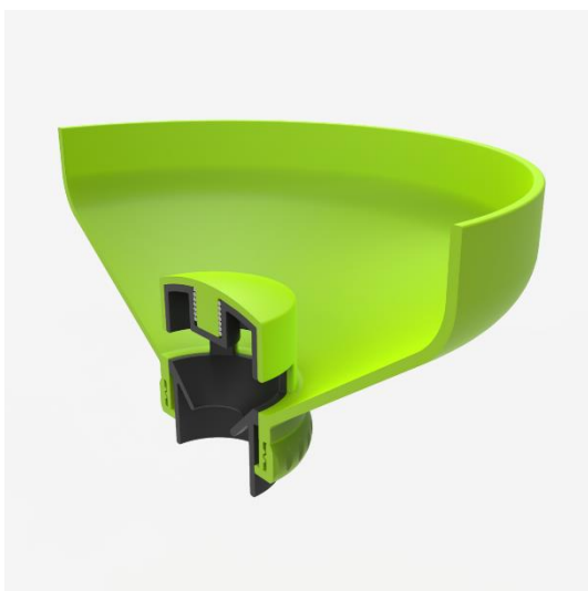
Obr. 11. Řez dávkovacím mechanismem
