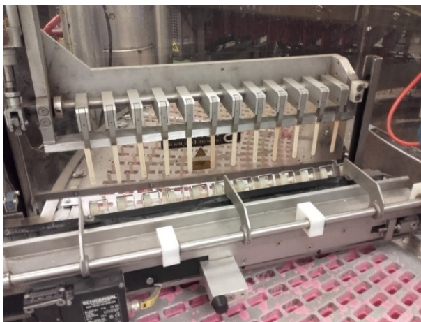
Obrázek 8 Technologie plnění do forem – vkládání dřívěk (9)
