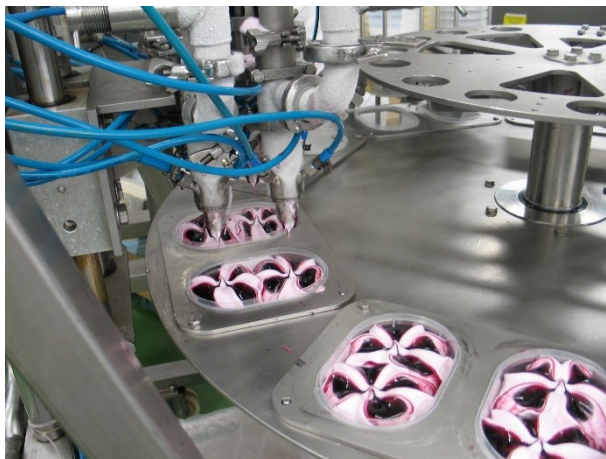
Obrázek 13 Přímé plnění do malospotřebitelského balení (16)
