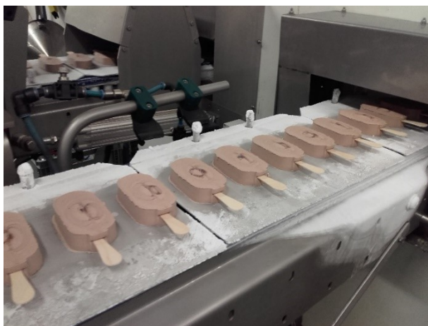
Obrázek 11 Extruzní výrobek – po vytvarování (16)
