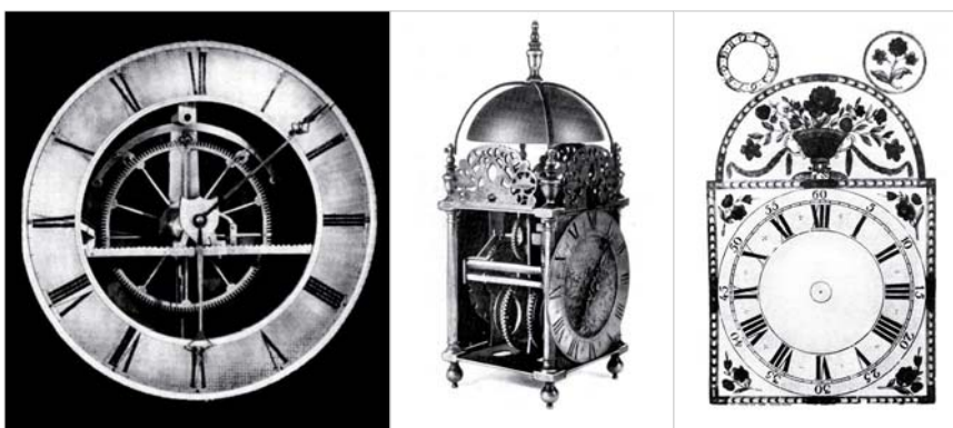
Obr. 24. Ciferníky skeletové, prstencové a tištěné na papíře
