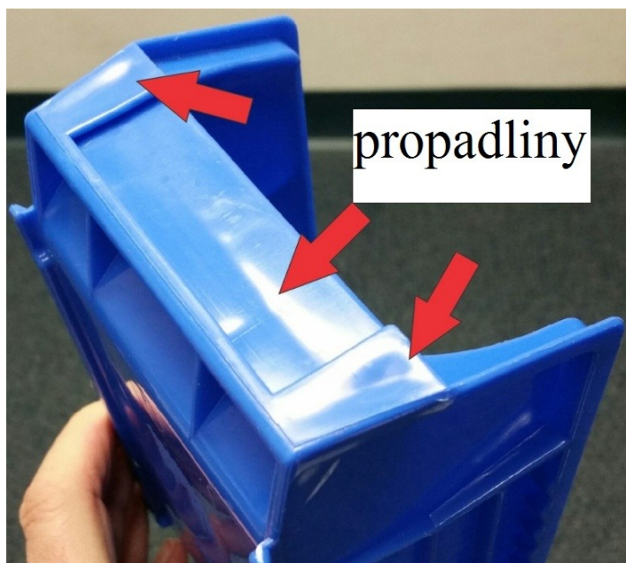
Obr. 15 – Místa s propadlinami [30]
