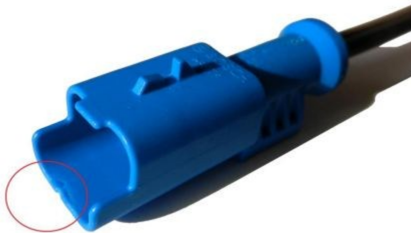
Obr. 14 – Spálená místa na výrobku (diesel efekt) [31]
