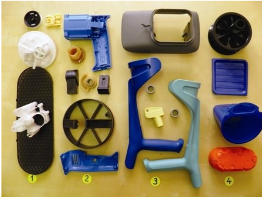
Obr. 12 – Semikrystalické termoplasty: 1 – polyformaldehyd POM; 2 – polyamidy PA 6, PA 6,6; 3 – polypropylen a kopolymery PP; 4 – polyetyleny PE [11]
