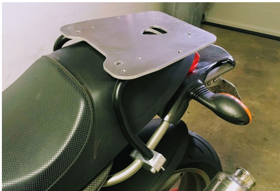
Obr. 39 – Nosič uchycen k rámu motocyklu pomocí navrhované součásti
