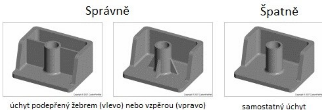
Obr. 4 – Úchyty pro upevňovací prvky [5]
