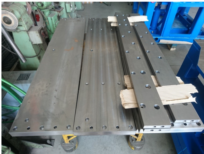
Obr. 55. Frézované díly dutiny - bočnice a základna
