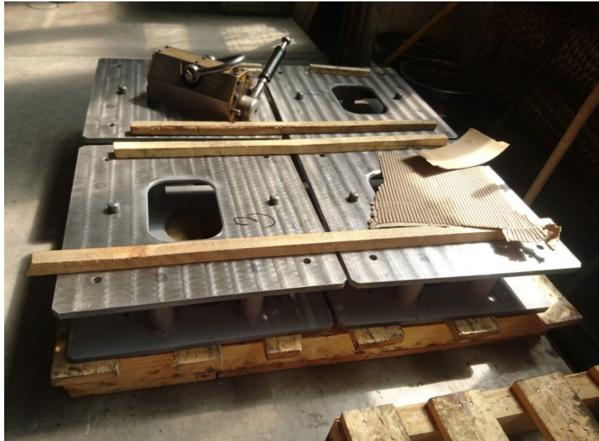
Obr. 56. Svařované stolice po žihání a obrobení upínacích ploch
