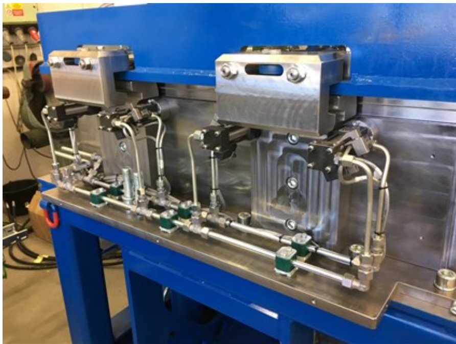
Obr. 59. Rozvody k hydraulickým válcům vyjížděcích válečků
