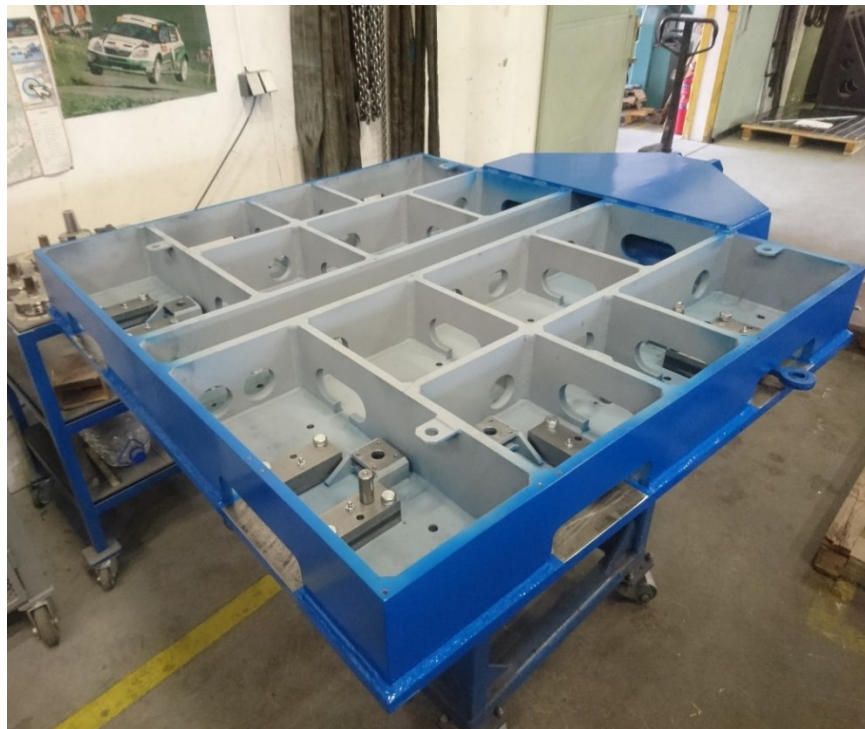
Obr. 57. Opracovaný a natřený rám vika s již částečně provedenou instalací zámků
