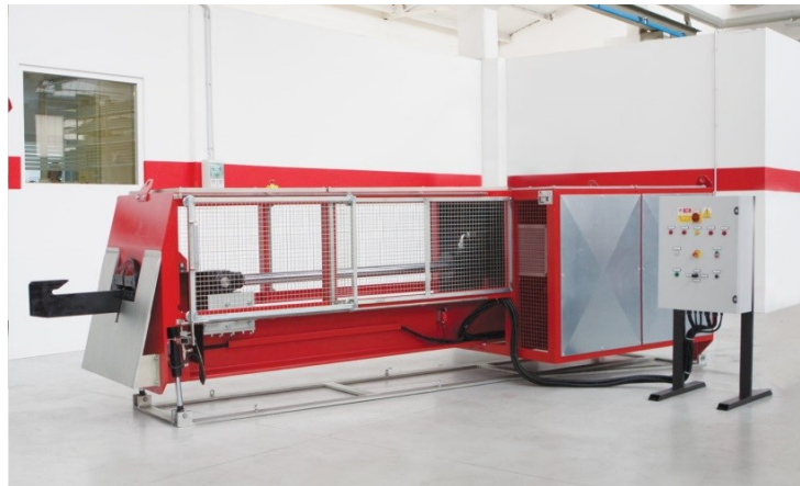
Obr. 19. Zařízení na vytrhávání patních lan Hercules 45 firmy Salvadori [36]
