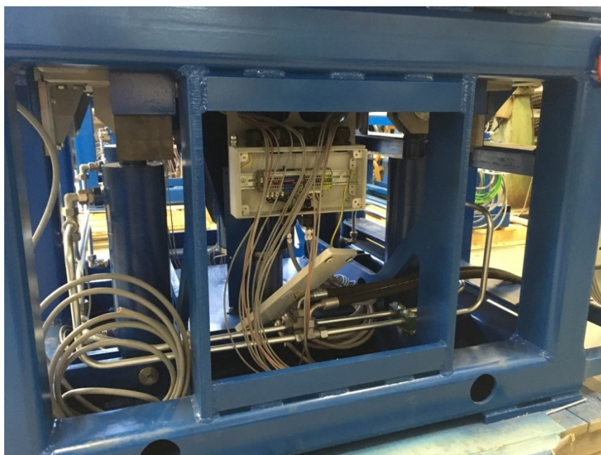
Obr. 61. Zapojování svorkovnice tlačného stolu
