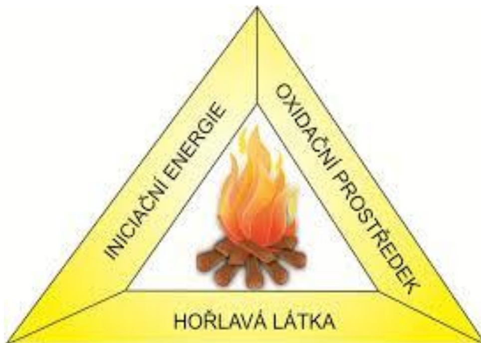
Obr. 5 Schematické znázornění podmínek procesu hoření (26)
