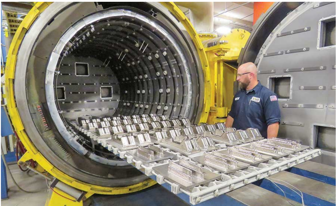
Obr. 26 Vakuová pec pro tepelné zpracování výrobku [34].
