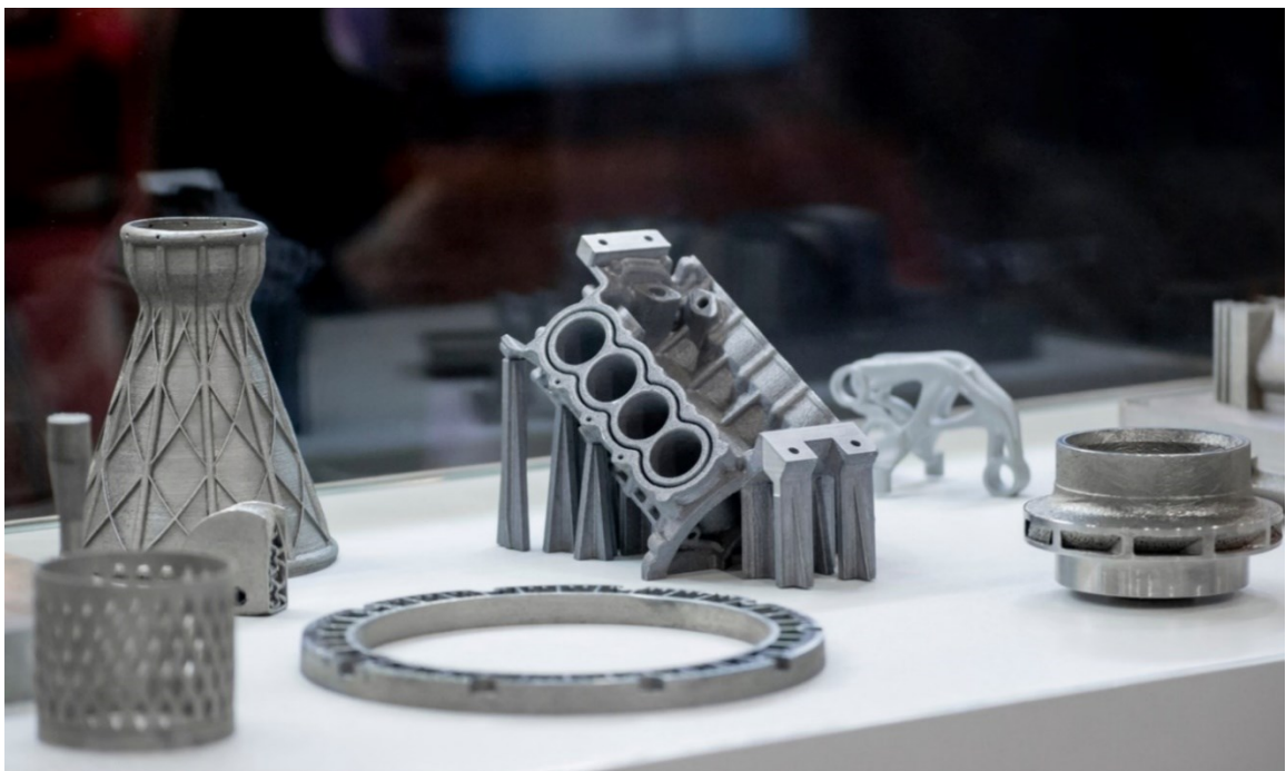
Obr. 16 Součásti vyrobené metodou DMLS s náročnou geometrií [23].
