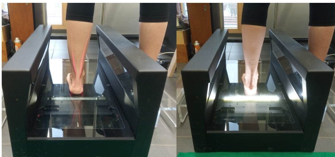
Obrázek 28: Skenování 3D chodidla metodou triangulace s viditelným laserovým paprskem (vlevo), pořizování 2D snímku chodidla (vpravo)
