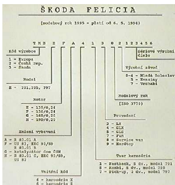
Obr.29. Struktura čísla VIN u vozidla Škoda Felicia
