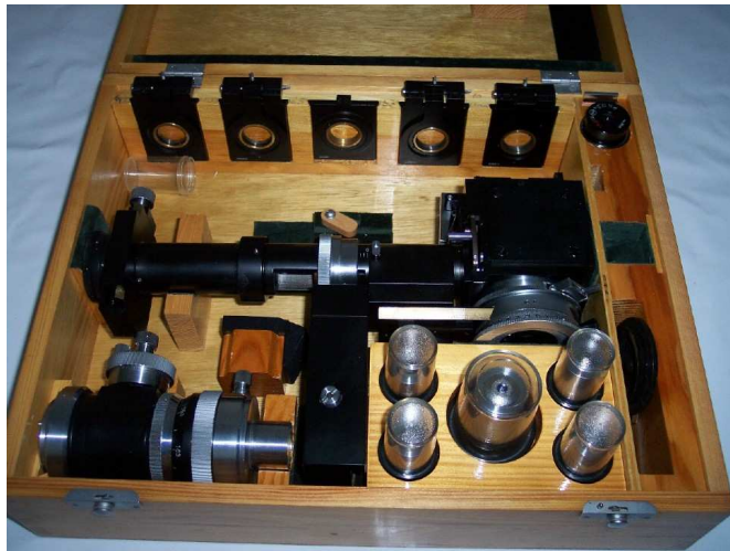
Obr.24. Metalografický mikroskop NEOPHOT 2 od firmy Carl Zeiss Jena
