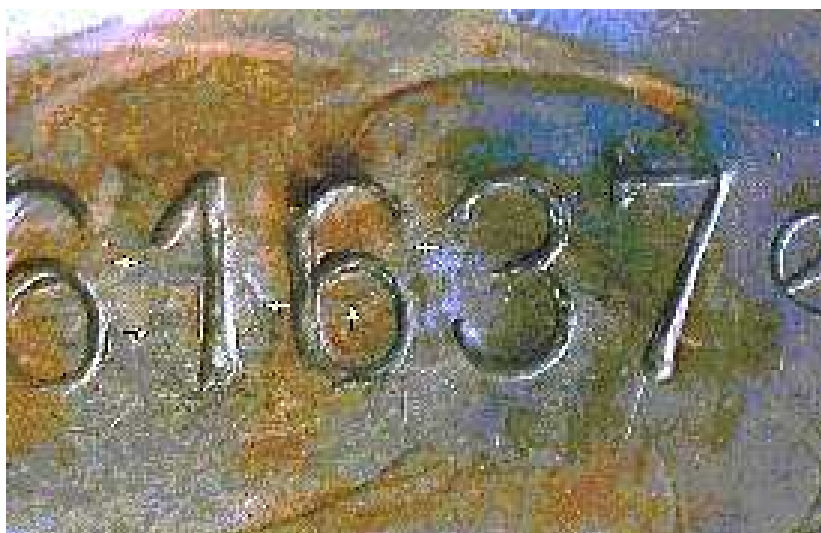
Obr.32. Výsledek chemického leptání u automobilu Mercedes po cca 5 až 6 hodinách (pod číslicí "1" je viditelná číslice "6" a pod číslicí "6" je číslice "9" – označeno šipkami)
