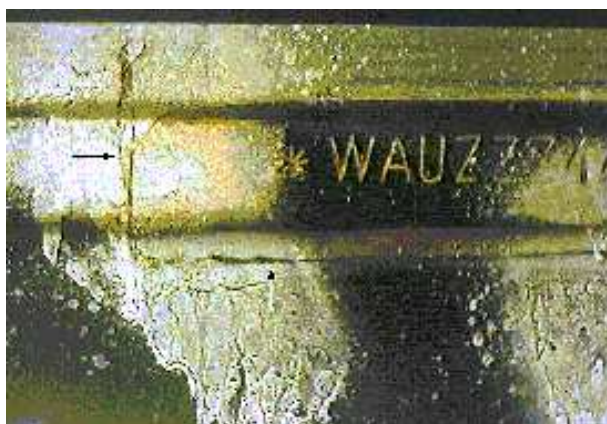
Obr.30. Výsledek magnetické práškové metody za použití denního světla
